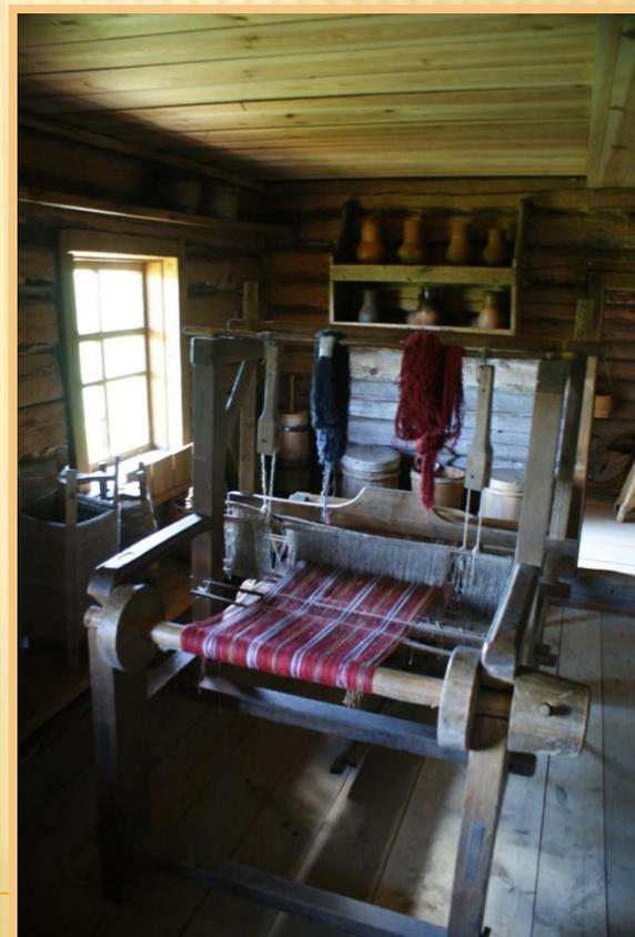
**КРОСНЫ – РУЧНОЙ ТКАЦКИЙ СТАНОК**
