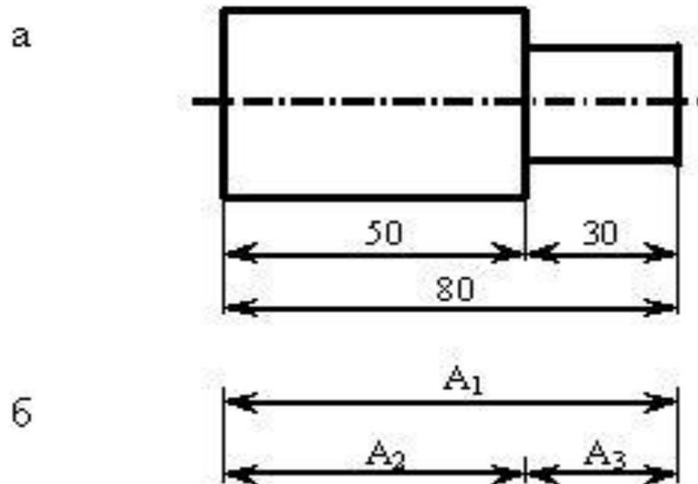
Рис. 6.1. Размерная цепь элементов детали: а – эскиз детали, б – размерная цепь
