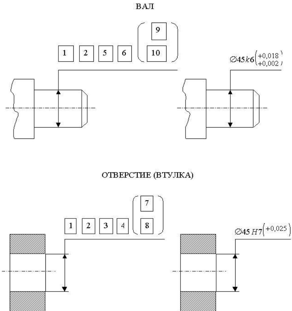
Рис. 2.12. Обозначение допусков на чертежах деталей (номера зон соответствуют рис. 2.11)
