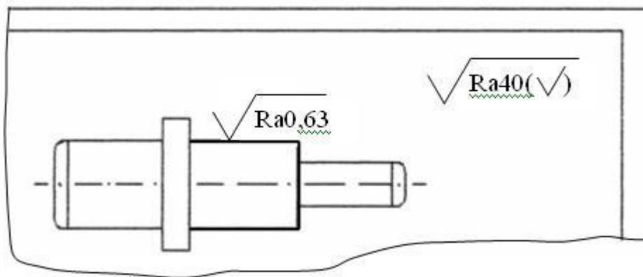
Указание требований к поверхностным неровностям, одинаковым для нескольких элементов детали
