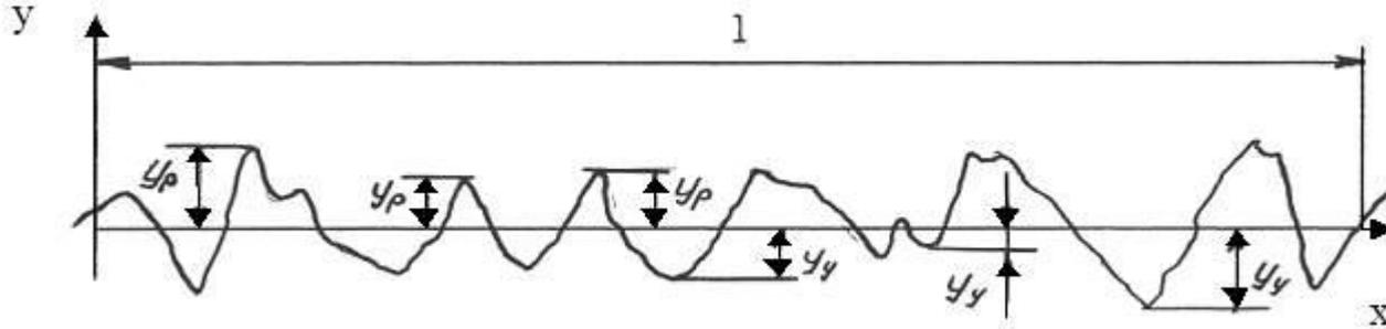
Рис. 4.1. Поверхностные неровности
