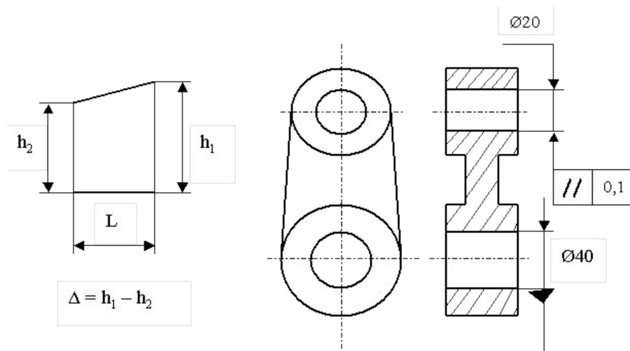
Рис. 3.8. Отклонение от параллельности осей в плоскости
