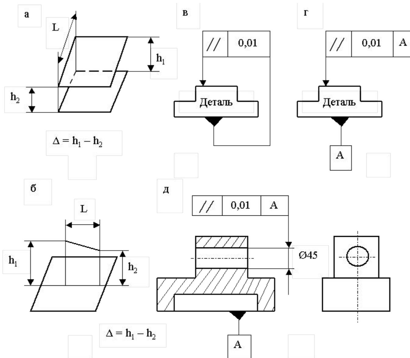
Рис. 3.7. Отклонение от параллельности:
