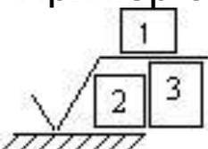
1 - способ обработки поверхности.
