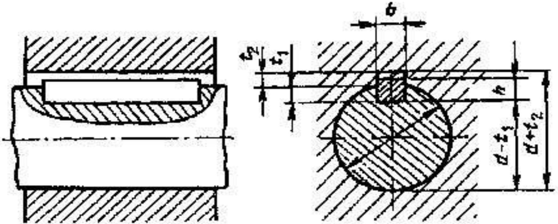
Рис. 10.1. Шпоночное соединение призматическими шпонками
