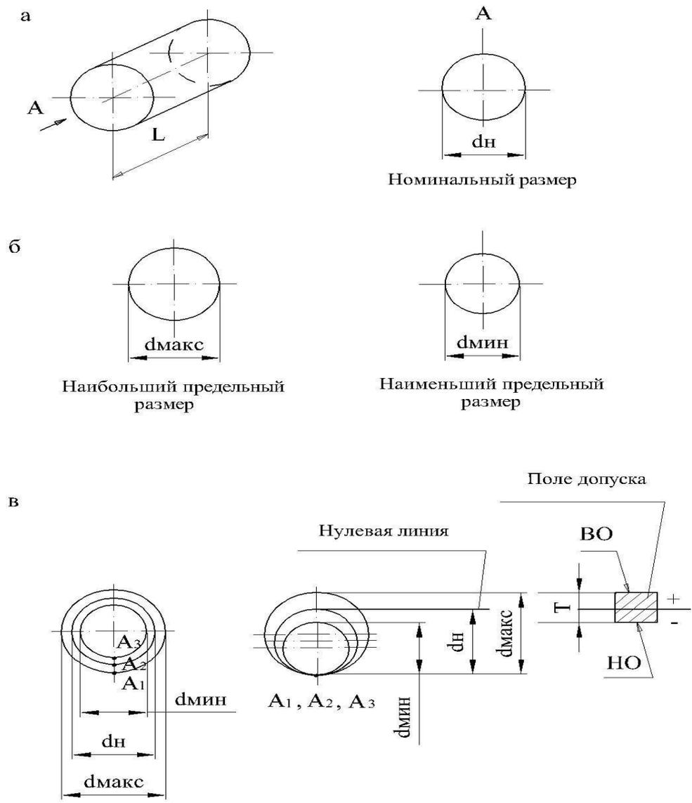
Рисунок 2 – Отверстия и валы: а, б, в – виды соединений элементов деталей;
