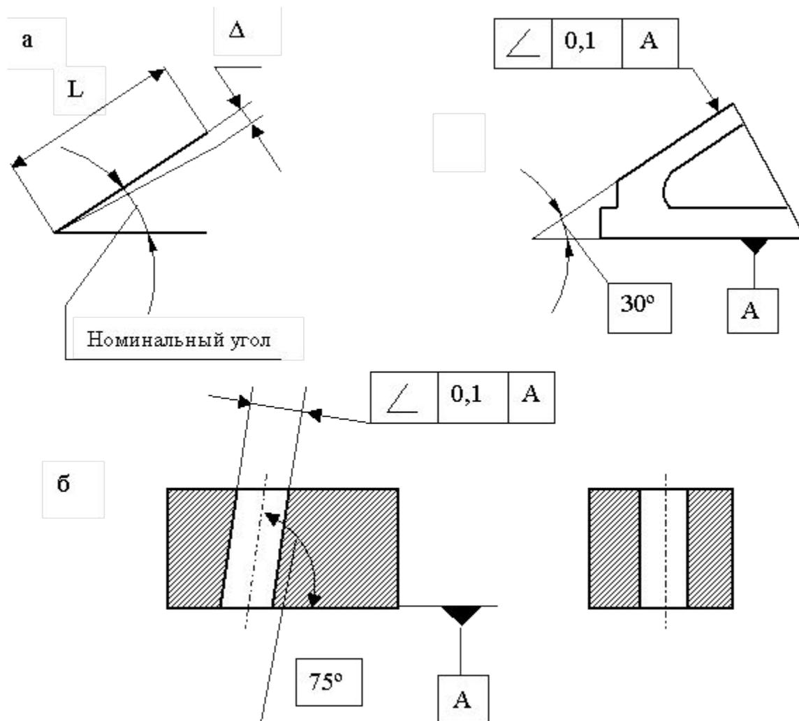
Рис. 3.11. Отклонение наклона:
