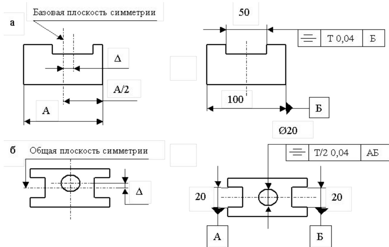
Рис. 3.13. Отклонение от симметричности:
