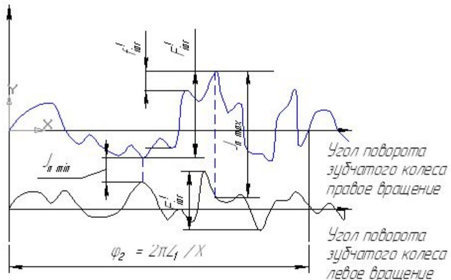
Полный цикл измерения относительного положения зубчатых колес
