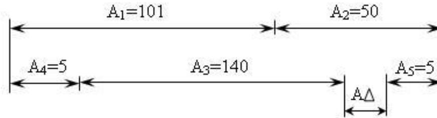
Рис. 6.7. Размерная цепь редуктора (см. рис. 6.6)
