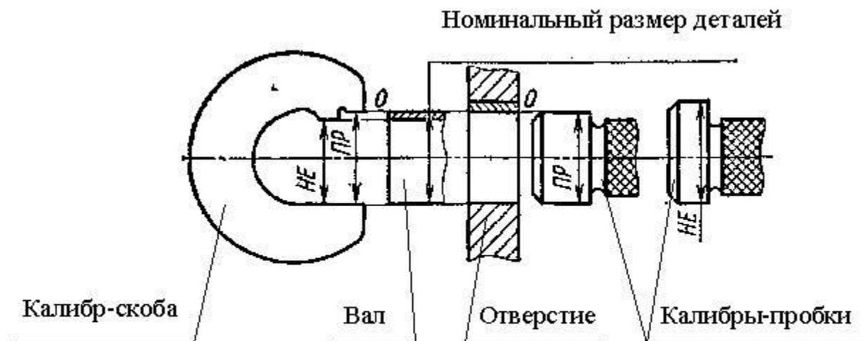
Рис. 2.13. Схема для выбора номинальных размеров предельных гладких калибров
