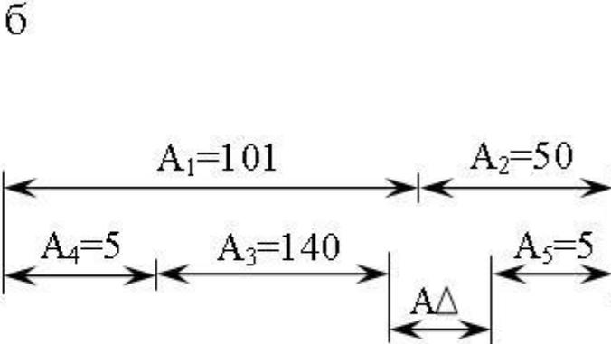
Рис. 6.6. Эскиз редуктора (а) и его размерная цепь (б)
