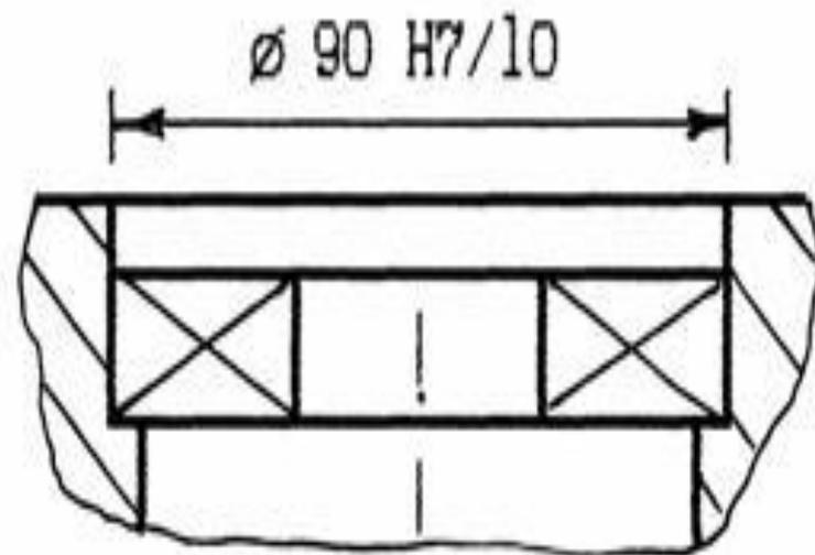
Рис. 5.3. Обозначение на сборочном чертеже посадок подшипника
