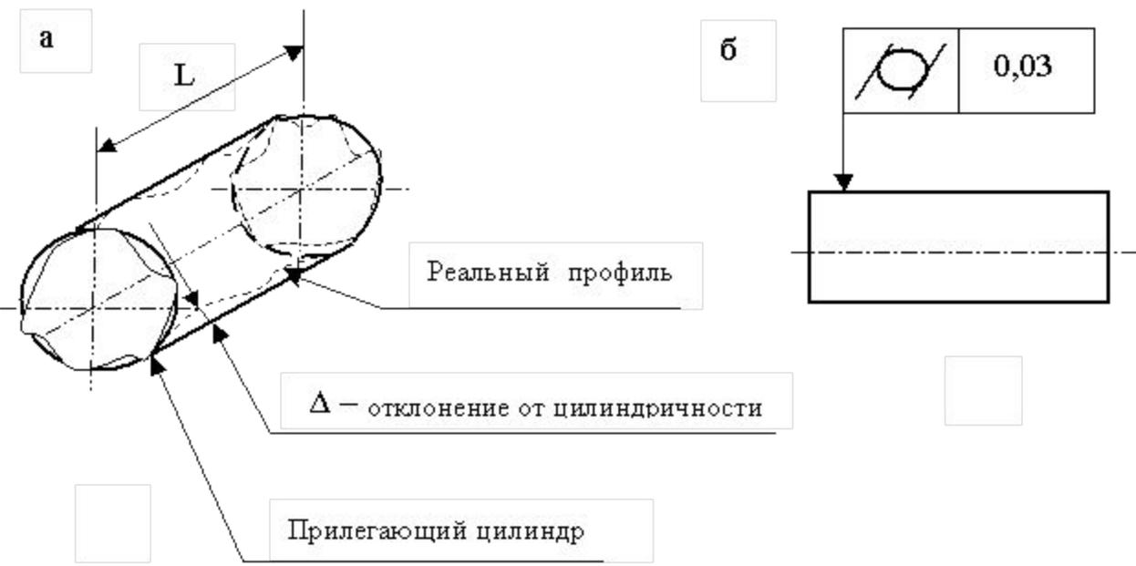
Рис. 3.3. Отклонение от цилиндричности:
