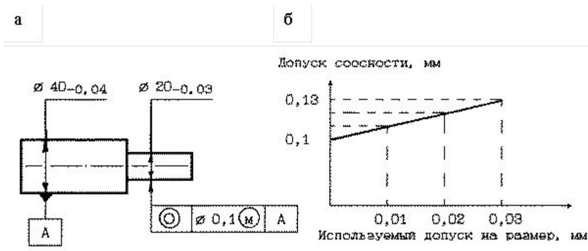
Рис. 3.22. Допуск отклонения от соосности, зависящий от действительного размера (а) и значения допуска при разных значениях действительного размера (б)
