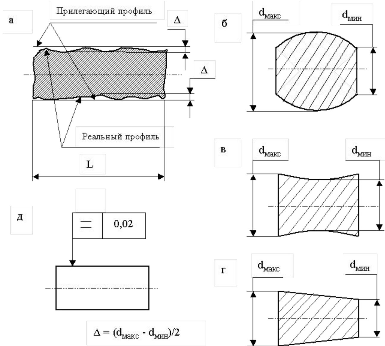
Рис. 3.6. Отклонение профиля продольного сечения:
