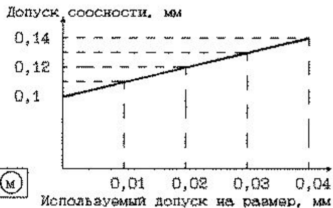
Рис. 3.23. Допуск отклонения от соосности, зависящий от действительного размера (а) и значения допуска при разных значениях действительного размера (б)
