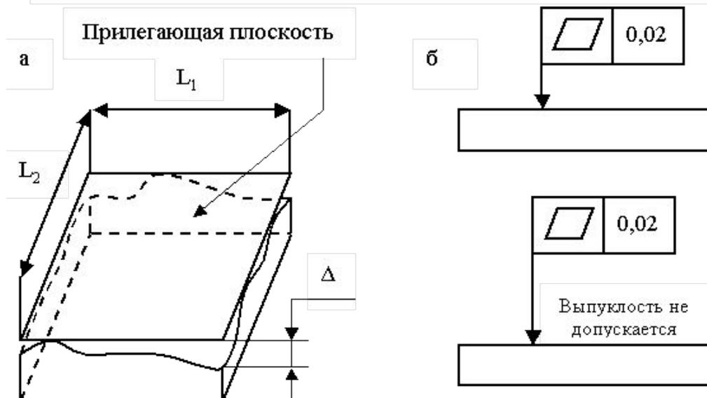
Рис. 3.2. Отклонение от плоскостности:
