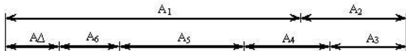
Рис. 6.3. Сложная размерная цепь с параллельными ветвями
