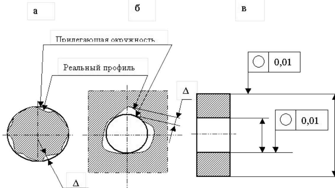
Рис. 3.4. Отклонение от круглости поверхностей:
