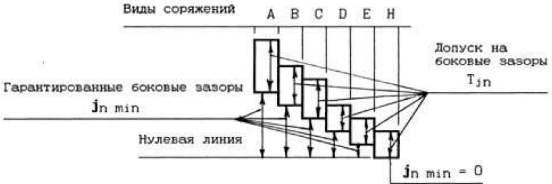
Схема расположения полей допусков  $T_{jn}$  для принятых видов сопряжений зубьев зубчатых колес
