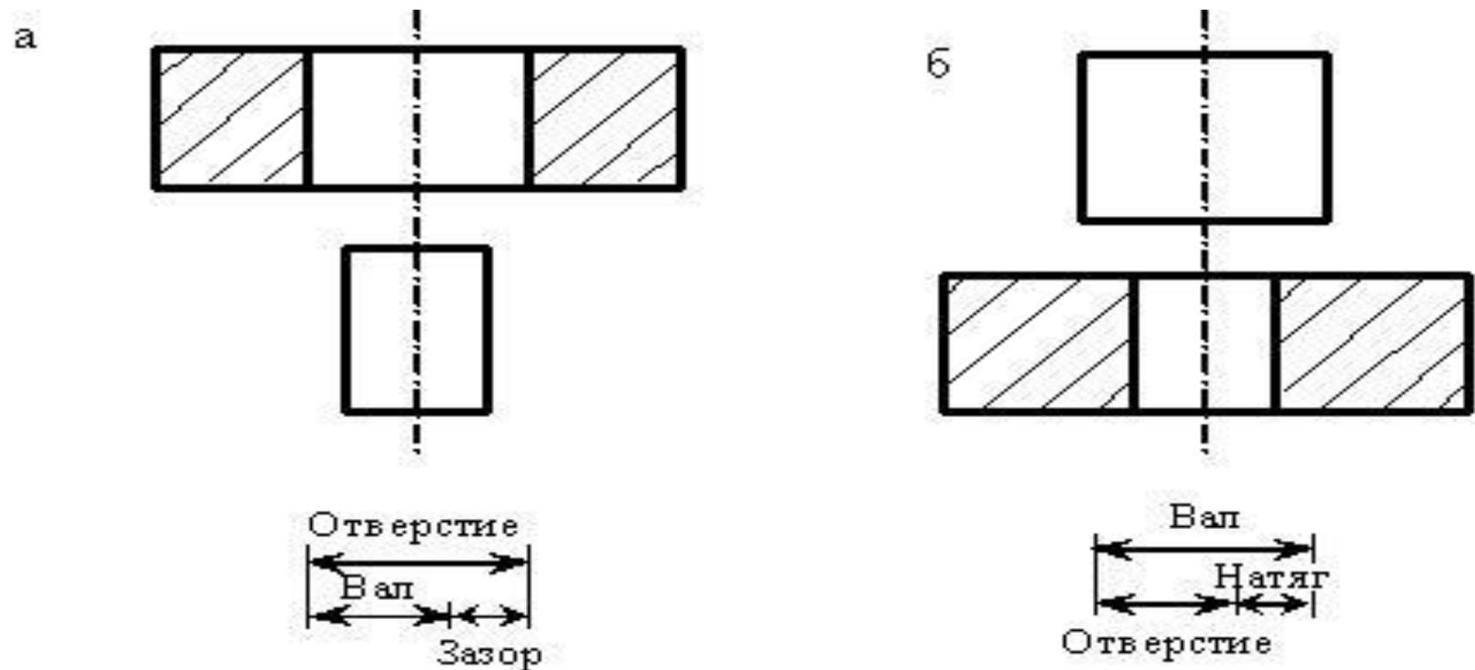
Рис. 6.2. Размерные цепи при образовании посадок:
