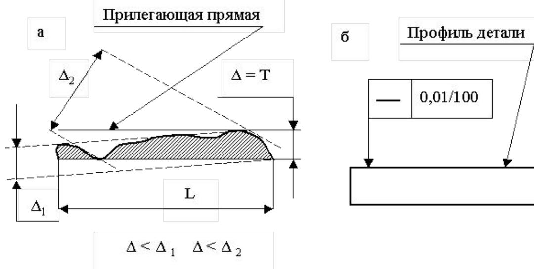
Рис. 3.1. Отклонение от прямой в плоскости:
