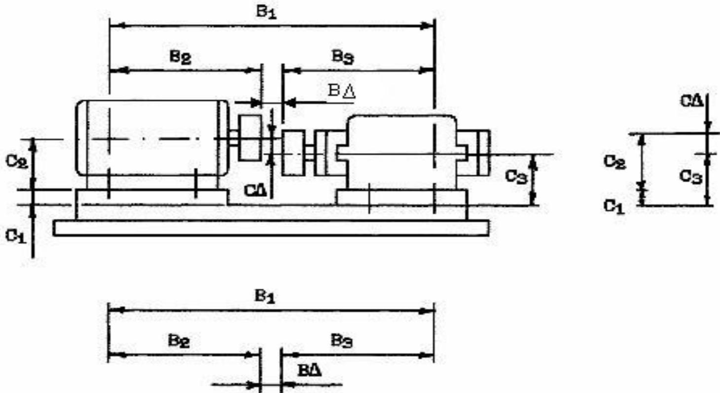
Рис. 6.4. Сборочная размерная цепь
