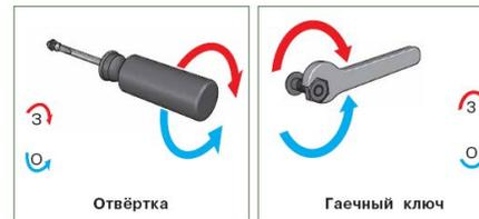
Винт завинчивается (3) отвёрткой по часовой стрелке, а отвинчивается (O) против часовой стрелки. Чтобы при завинчивании и отвинчивании винта гайка не проворачивалась, её поддерживают гаечным ключом.
