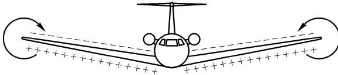
Рис. 30. Образование концевых вихрей на крыле конечного размаха
