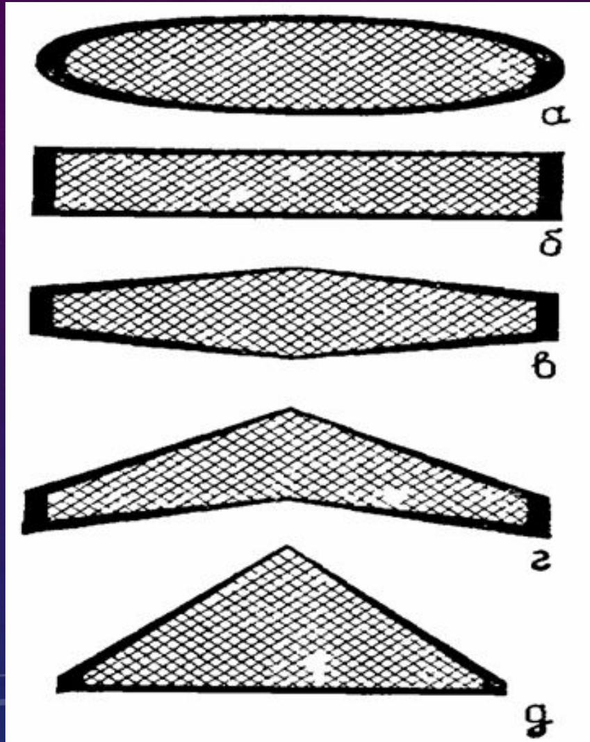
Геометрические характеристики крыла сводятся в основном к характеристикам формы крыла в плане и к характеристикам профиля крыла.
