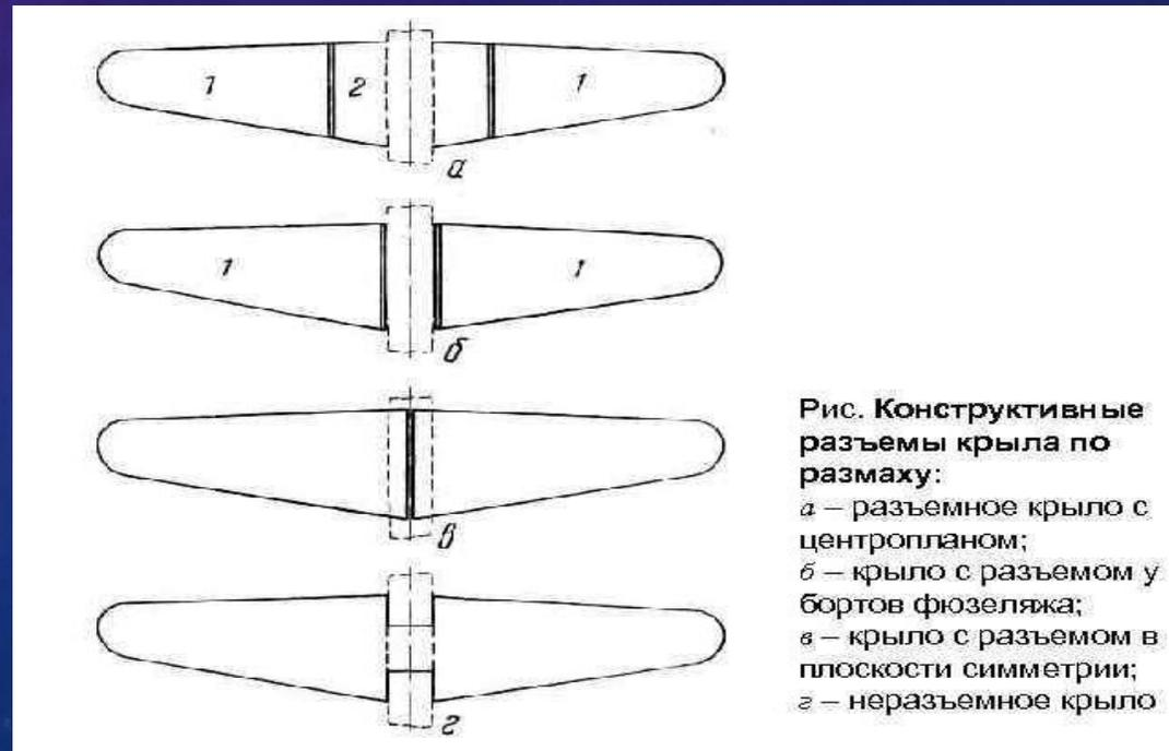
Рис. Конструктивные разъемы крыла по размаху:
