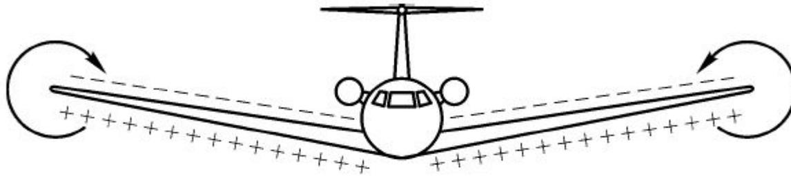
Рис. 30. Образование концевых вихрей на крыле конечного размаха
