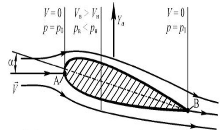
б) обтекание симметричного профиля при  $\alpha > 0$
