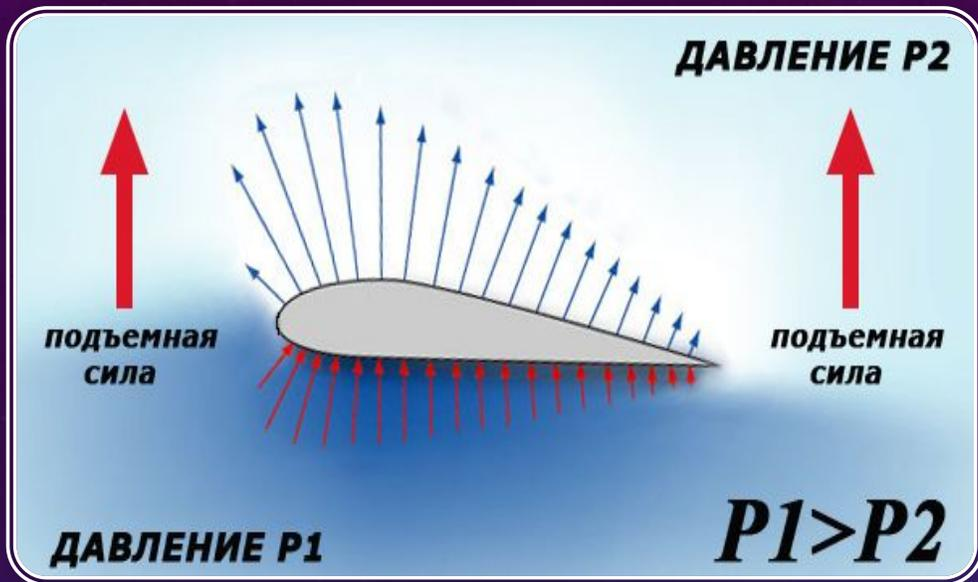
Воздух, обтекая крыло самолета, разделяется на два потока: над крылом и под ним. Нижний поток протекает себе как ни в чем не бывало, а верхний сужается. Ведь профиль крыла выпуклый сверху.
