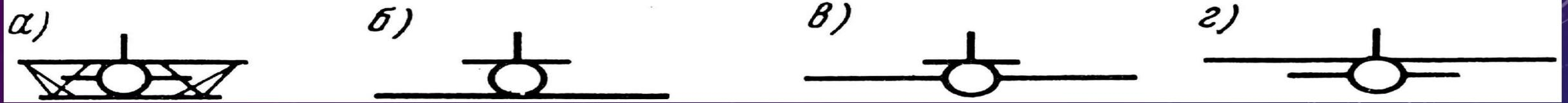
а – бипланы; б – низкопланы; в – среднепланы; г - высокопланы
