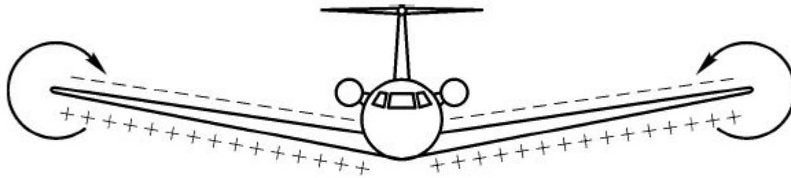
Рис. 30. Образование концевых вихрей на крыле конечного размаха
