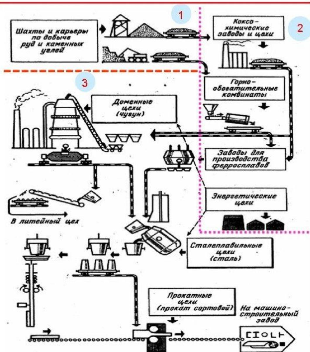
1 Комплекс производств обеспечивающих добычу как основных так и вспомогательных материалов
