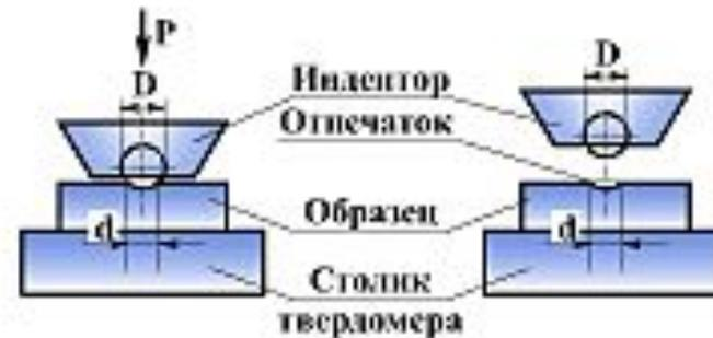
**Индентор** – стальной закаленный шарик диаметром  $D$ , равным 10, 5 или 2,5 мм;
