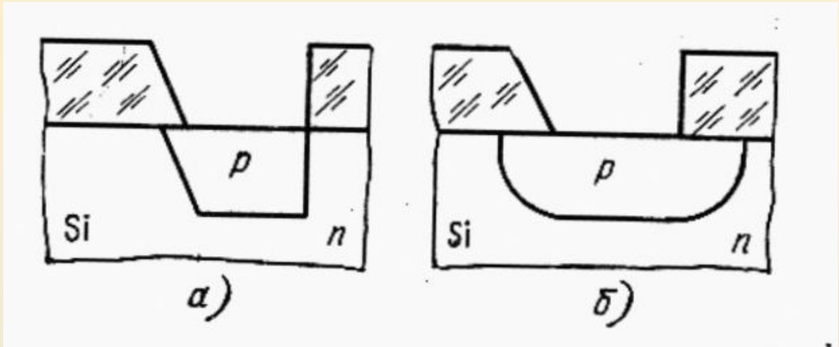
Маскирование производится пленками окиси кремния; или  $\text{Si}_3\text{N}_4$ , фоторезистами, поликремнием или пленками металлов
