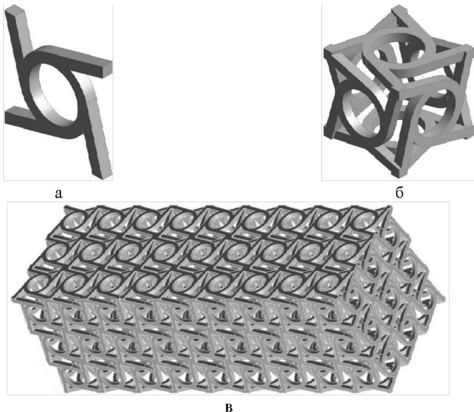
Рисунок 1 – Построение образца из метаматериала
