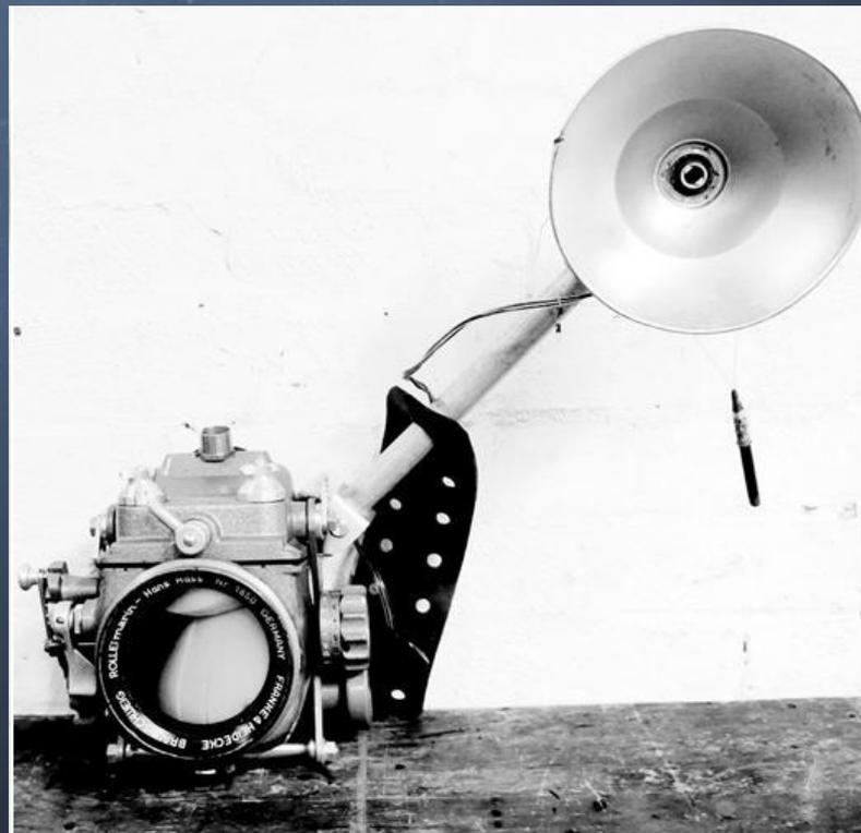
Водозащитный бокс, с камерой внутри
