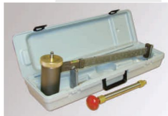
100-60 Рычажные весы Halliburton Tru-Wate™ для определения плотности под давлением
