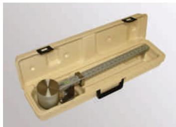
115-00 Металлические рычажные весы OFITE, в футляре
