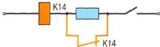
б) для гашения коммутационных перенапряжений, возникающих при отключении обмотки от источника питания.
