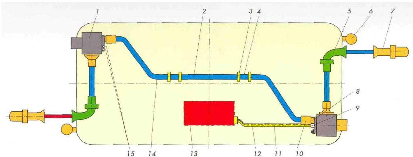
1 — розетка; 2 — магистральный провод; 3 — кольца; 4 — муфта нарезная; 5 — кронштейн; 6 — холостая розетка; 7 — штепсель; 8,9 — патрубки; 10 — резиновая манжета; 11 — питающий провод; 12 — бронированная стальная труба; 13 — ящик с высоковольтной аппаратурой; 14 — защитная алюминиевая труба; 15 — заглушка.
