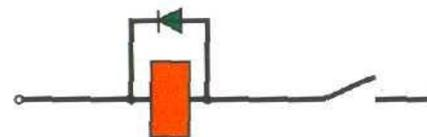
**Диоды можно применять только в схемах постоянного тока, поэтому реле с катушками переменного тока шунтируют только резисторами**
