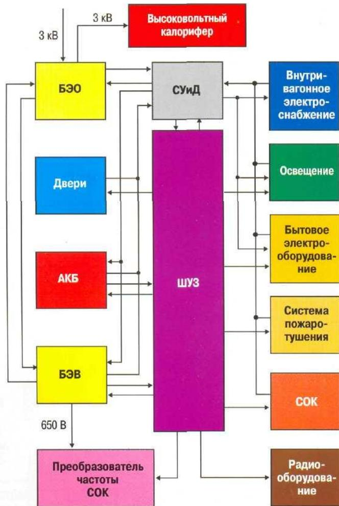
Напряжение магистрали +3 кВ поступает на вход БЭО, через высоковольтное оборудование которого данное напряжение подается в БЭВ.
