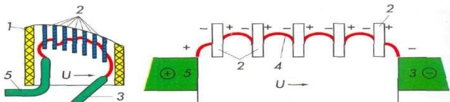
К дугогасительным устройствам, действие которых основано на разделении дуги на ряд коротких дуг, относят деионную решетку 2, встроенную внутрь дугогасительной камеры 1. Деионная решетка состоит из ряда отдельных пластин, изолированных друг от друга. Электрическая дуга 4, возникающая между размыкающимися контактами 3 и 5, разделяется решеткой на ряд более коротких дуг, соединенных последовательно. Число дуг, равное числу пластин решетки, выбирается таким, чтобы добиться надежного гашения дуги.
