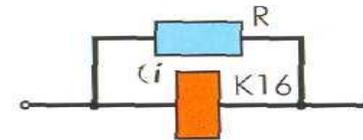
**Включенный резистор может привести к увеличению времени отпускания реле, поэтому для этих же целей чаще используют диоды, включаемые параллельно катушке реле:**
