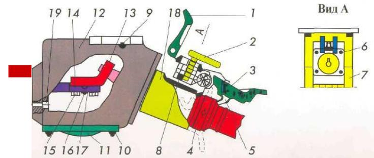
1, 3, 11 — крышки; 2 — ключ; 4 — штепсель; 5 — упор; 6 — винт крышки замка; 7 — корпус замка; 8 — замок; 9, 19 — болты заземления; 10 — гайки; 12, 18 — корпуса; 13 — колодка; 14 — прижим; 15 — болт; 16 — винт; 17 — контргайка.
