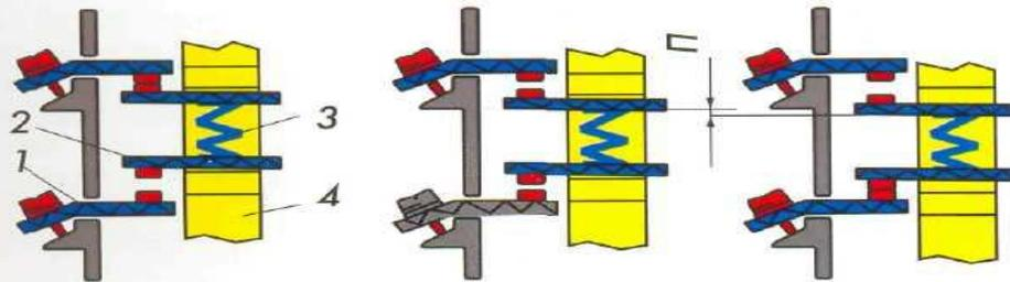
Плоскостные контакты применяют для контакторов средней и большой мощности.
