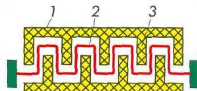
Электрическая дуга 2 под действием магнитного поля и потока воздуха попадает в узкие щели или лабиринт камеры 1, где она соприкасается со стенками и перегородками 3, отдает им тепло и гаснет. Широкое применение в электрических аппаратах находят лабиринтно-щелевые камеры, где дуга удлиняется не только путем растягивания между контактами, но и вследствие ее зигзагообразного искривления между перегородками камеры.
