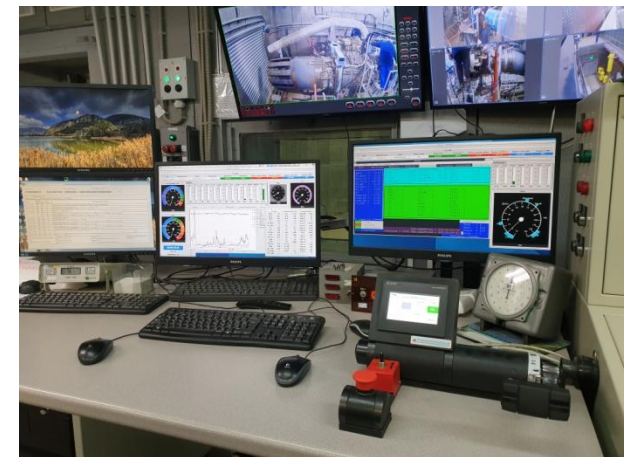
Варианты исполнения АРМ с ПО ИДК-42 и электронной системой управления рычагом подачи топлива ГТД (РУД)
