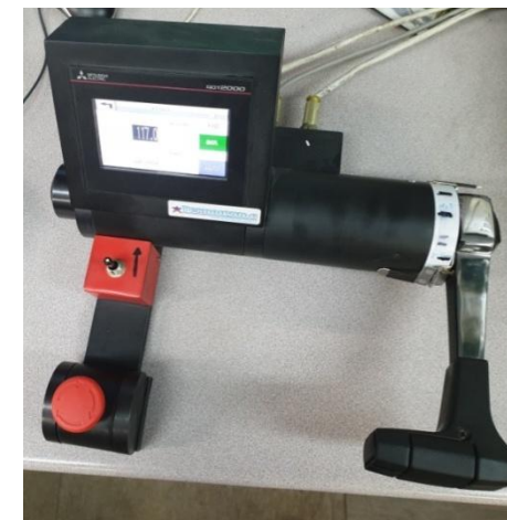
Система управления рычагом подачи топлива ГТД (РУД) и поворота стоп крана (РОД)
