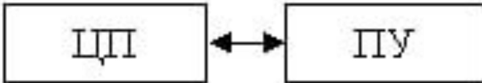
**Косвенный** метод состоит в том, что между **ЦП** и **ПУ** помещается канал – специальный процессор, который фактически управляет вводом-выводом. С **ЦП** снимаются несвойственные ему функции по управлению **ПУ**, остаются лишь функции управления каналом. **ЦП** только инициирует ввод-вывод, а затем может выполнять свои программы (до момента окончания процесса ввода-вывода). При этом **ЦП**, канал и **ПУ** по мере развития внешнего процесса работают параллельно.
