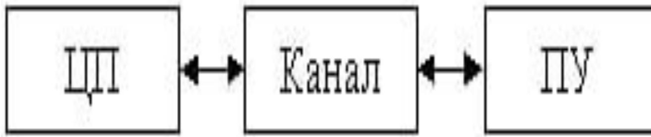
Для синхронизации параллельной работы **ЦП** и канала используют различные средства. В простейшем случае это флажок, в других случаях **ЦП** может быть доступна расширенная статусная информация о состоянии канала, контроллера и устройства. Такие средства предполагают некоторую периодичность проверок занятости канала со стороны **ЦП**.
