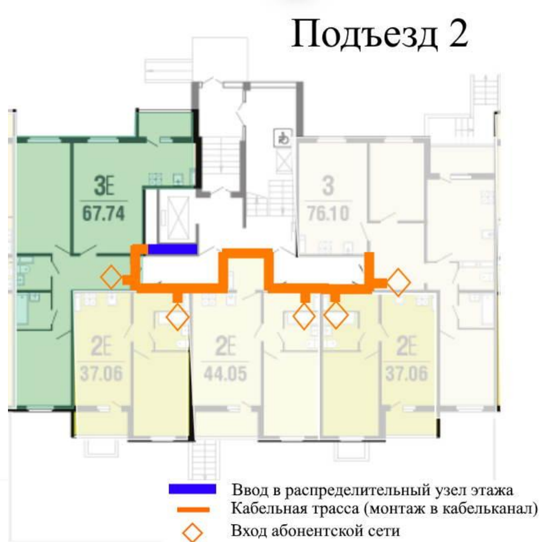
Рисунок 8 – Кабельная трасса распределительной сети этажа 1 подъезд 2
