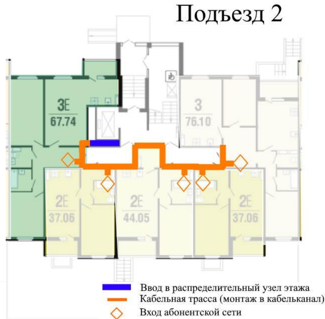
Рисунок 8 – Кабельная трасса распределительной сети этажа 1 подъезд 2
