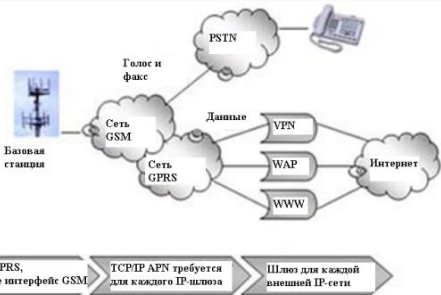
Рис. 5. Протокол GPRS: Схема работы.
