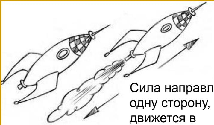
Сила направлена в одну сторону, ракета движется в противоположную
