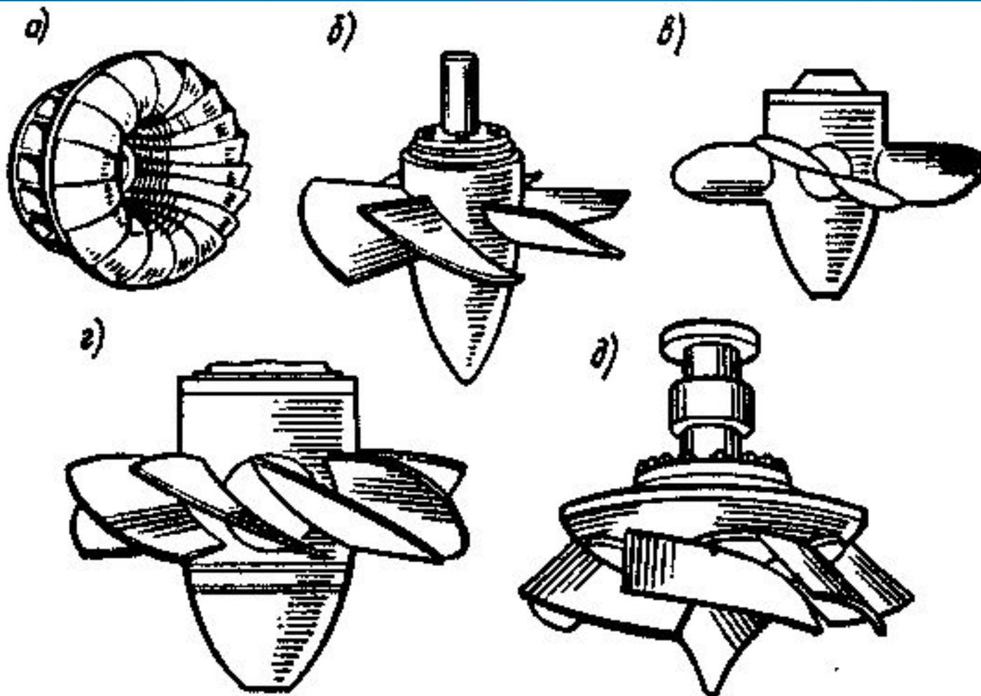
Рис. 2.19. Общий вид рабочих колес реактивных турбин:
