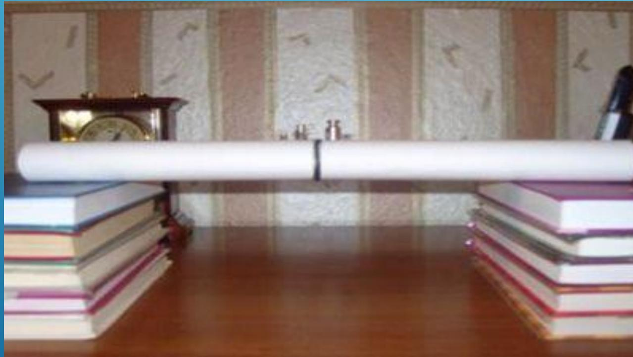
С помощью выше поставленного опыта, мы поняли, что использование полого цилиндра увеличивает жесткость конструкции. Выясним, как влияет изменение диаметра этого полого цилиндра на его жесткость.
