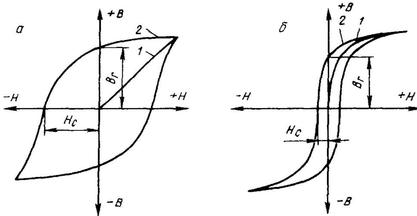
Рис. Зависимость магнитной индукции  $B$  от напряженности магнитного поля  $H$ . а) магнитотвердые материалы; б) магнитомягкие материалы; 1 – первичная кривая намагничивания, 2 – гистерезисная кривая намагничивания.
