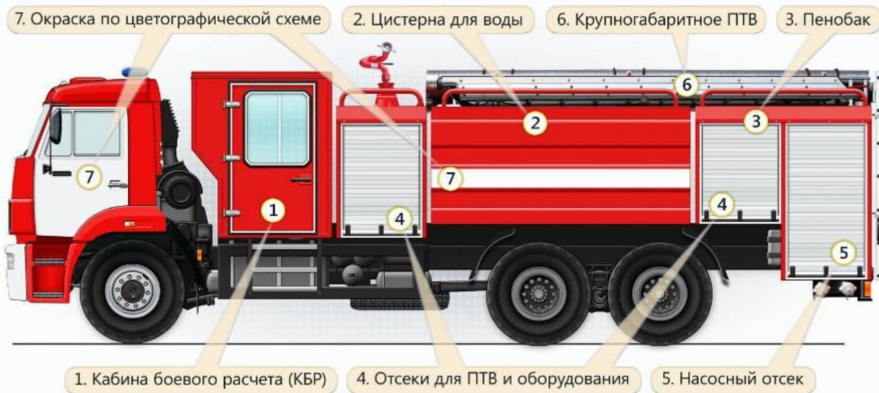
Устройство пожарной машины
