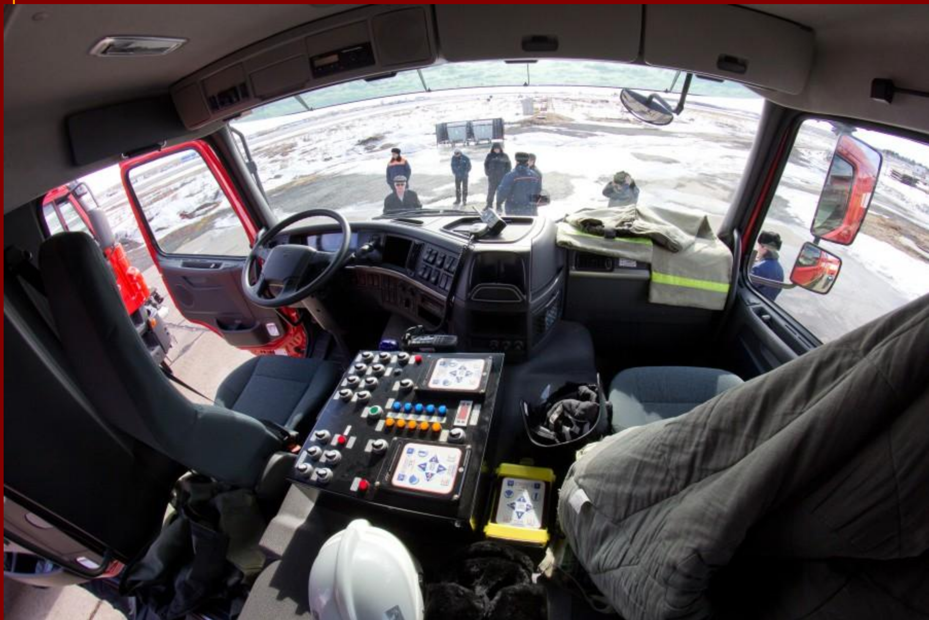
Панель управления пожарной машиной
