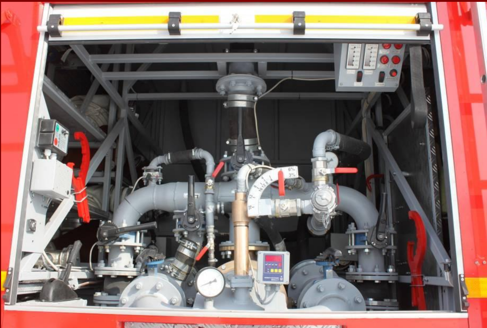
Пульт управления в заднем отсеке АЦ 7,0 на базе КАМАЗ-65224
