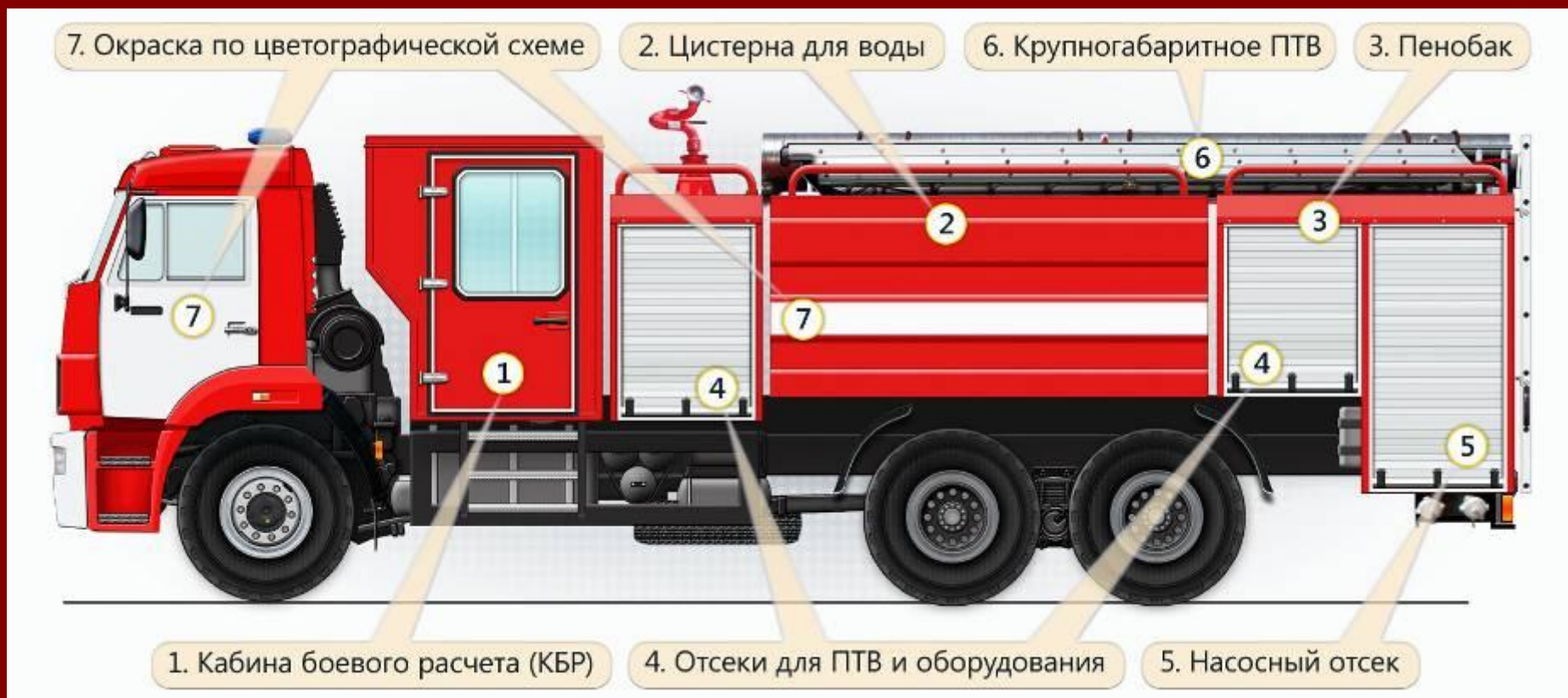
Устройство пожарной машины
