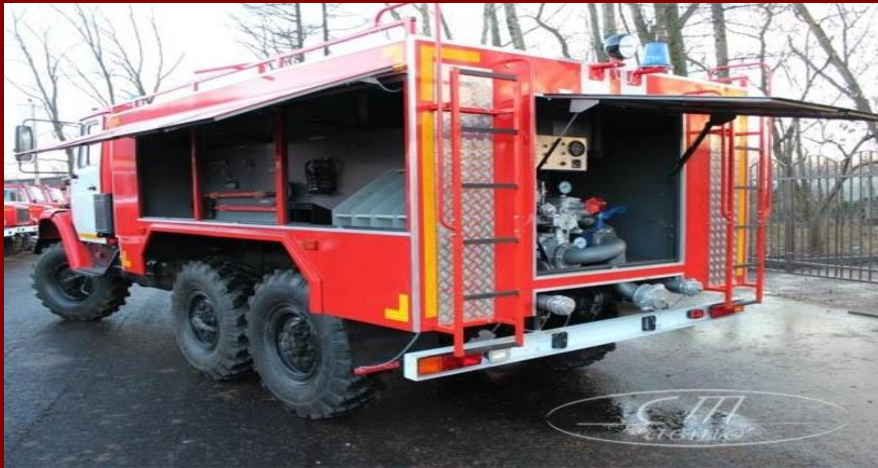
Установка и крепления пожарно-технического вооружения на АЦ 3,0 - 40 (4334)
