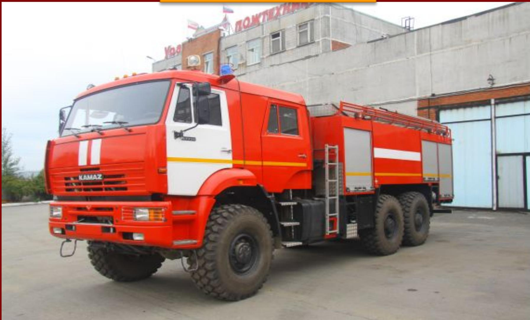
Автомобиль пенного тушения АРТ 7,0 на базе КАМАЗ-65224
