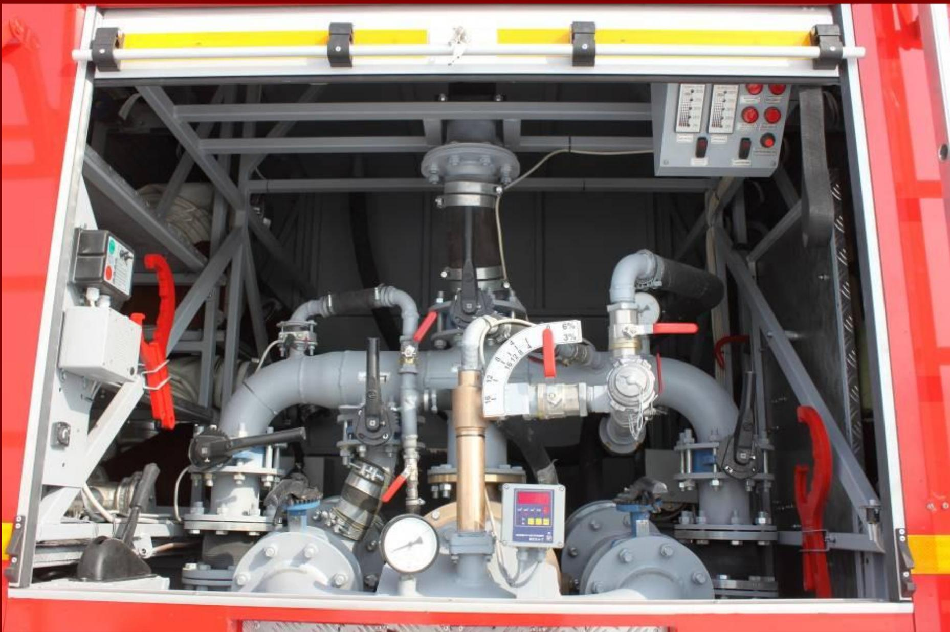
Пульт управления в заднем отсеке АЦ 7,0 на
