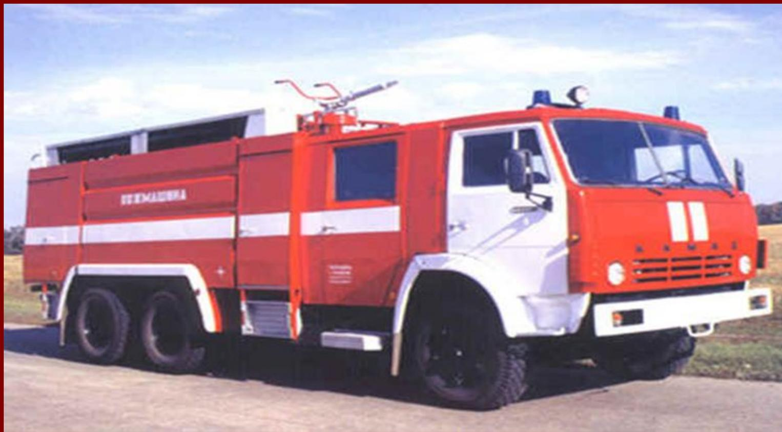
Автомобиль пожарный аэродромный АА-12/60 (63501)
