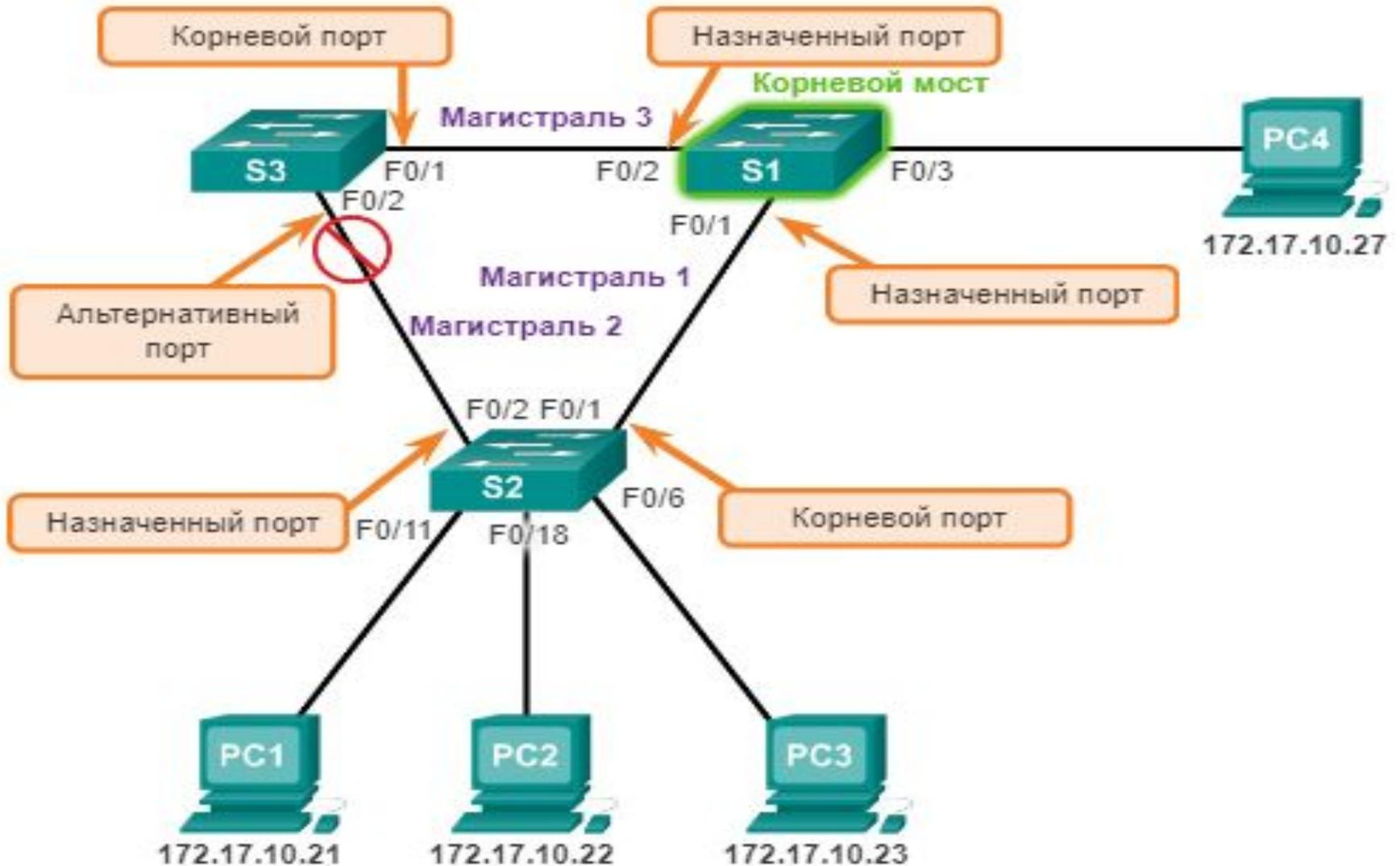
Все коммутаторы, участвующие в STP, обмениваются кадрами BPDU, чтобы определить, какой коммутатор имеет самое низкое значение идентификатора моста (BID) в сети. Коммутатор с наименьшим значением BID автоматически становится корневым мостом для расчётов STA.
