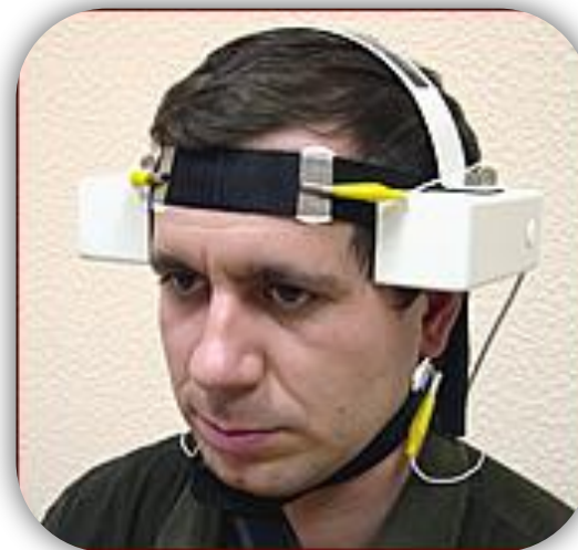
Общий вид излучателя "ОГОЛОВЬЕ" с электродами.
