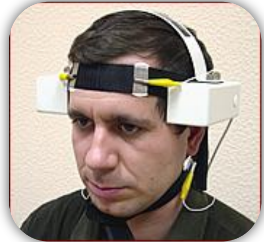
Общий вид излучателя "ОГОЛОВЬЕ" с электродами.
