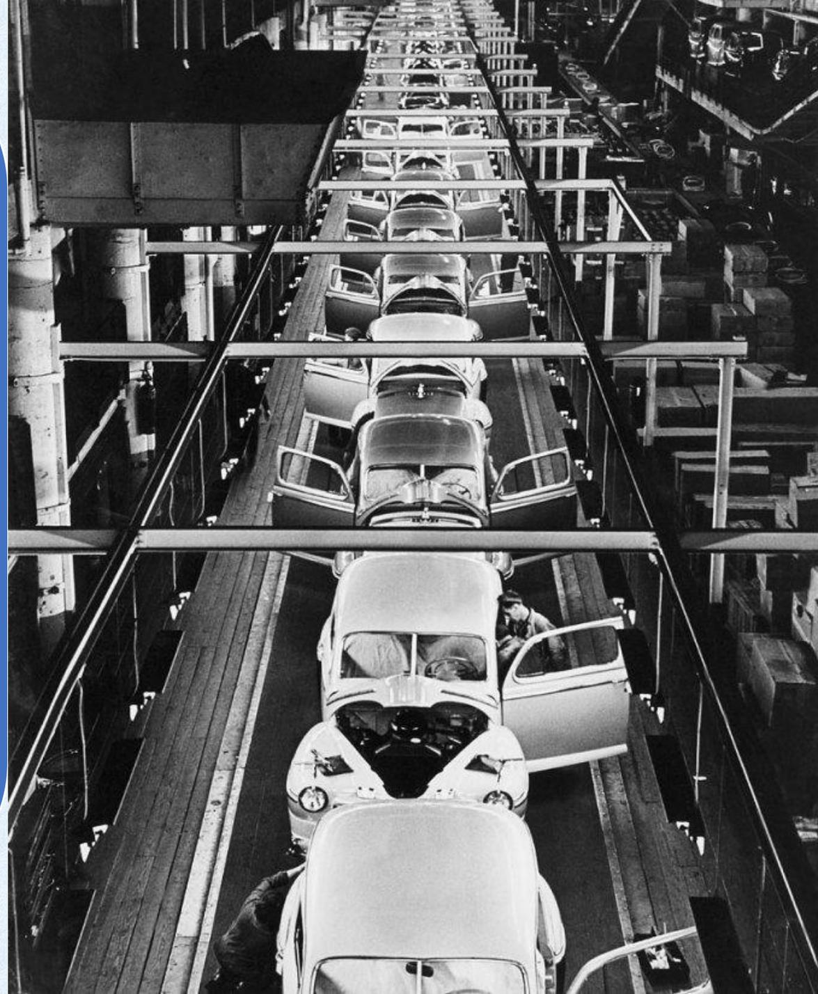
Форд применил стандартизацию и унификацию - важнейшие элементы в управлении качеством, организовал конвейерное производство, что дало возможность перейти к массовому производству автомобилей.
