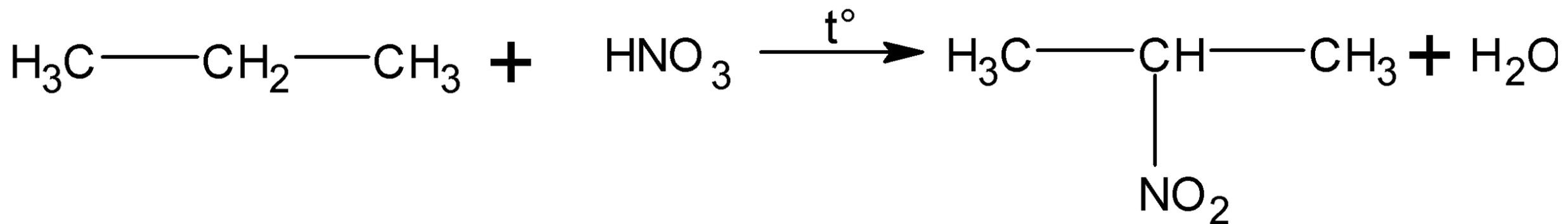
*Примечание:* протекают с разрывом связи C-H; в первую очередь замещаются атомы водорода у третичного, затем у вторичного, в последнюю очередь у первичного атома углерода
