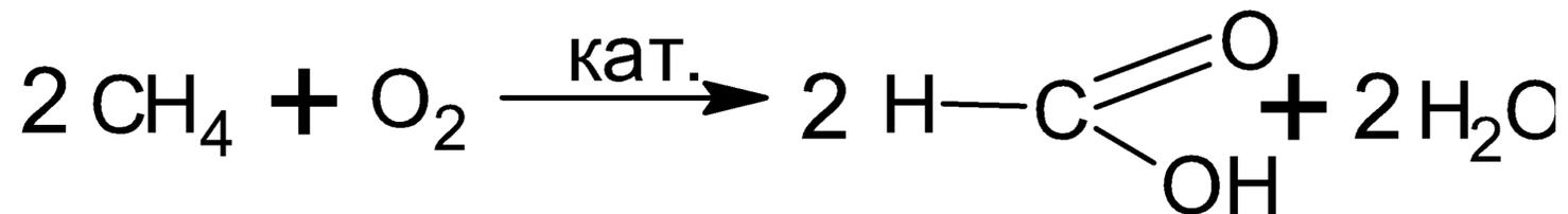
Гомологи метана окисляются при высоких температурах с разрывом углеродной цепи (C-C) и образованием преимущественно кислот:
