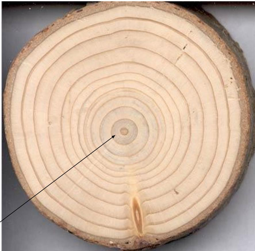
**Ядро** – самая темноокрашенная часть ствола, отличающаяся наибольшей плотностью, твердостью, прочностью и устойчивостью к загниванию.
