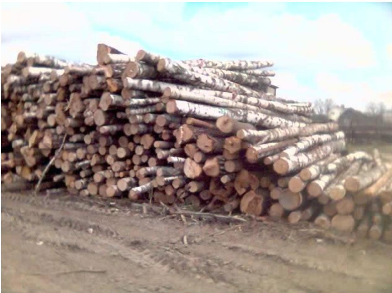
**Бревна** – отрезок хлыста, предназначенный для получения пиломатериалов или использования в круглом виде
