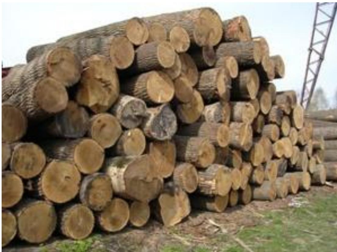
Чураки – отрезки кряжа, длина которых соответствует размерам, необходимым для обработки на станках
