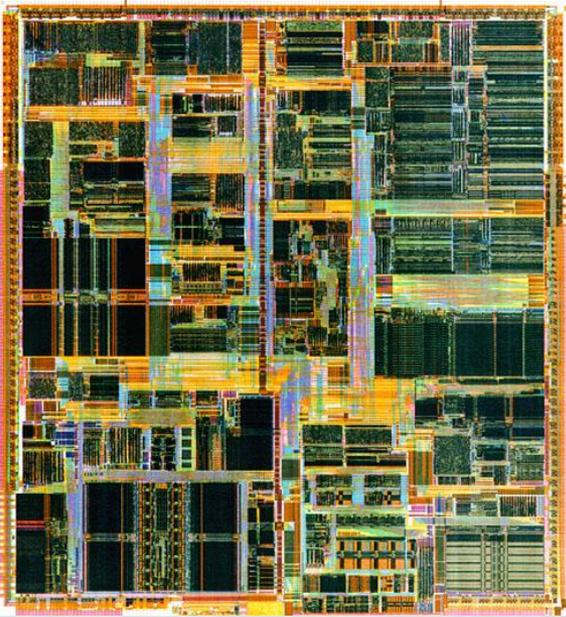
Процессоры *Intel* шестого поколения, построенный на архитектуре *x86* и анонсированный 7 мая 1997 года. *Pentium II* был основан на модифицированном *Pentium Pro* с добавленным блоком *MMX* и улучшенной обработкой 16-разрядных приложений. В системах, построенных на базе *Pentium II*, начал использоваться новый стандарт памяти — *SDRAM*, а также новая графическая шина — *AGP*.
