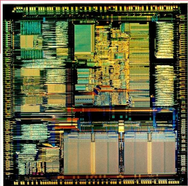
Обладея полностью 32-битной архитектурой, 386-й процессор адресовал до 4 Гб ( $2^{32}$  байт) физической оперативной памяти и до 64 Тб виртуальной. Он состоял из 275 000 транзисторов. Толщина транзисторных элементов, как и у 286-го, составляла 1.5 мкм (в дальнейшем - 1 мкм), а число ножек увеличилось с 68 до 132.
