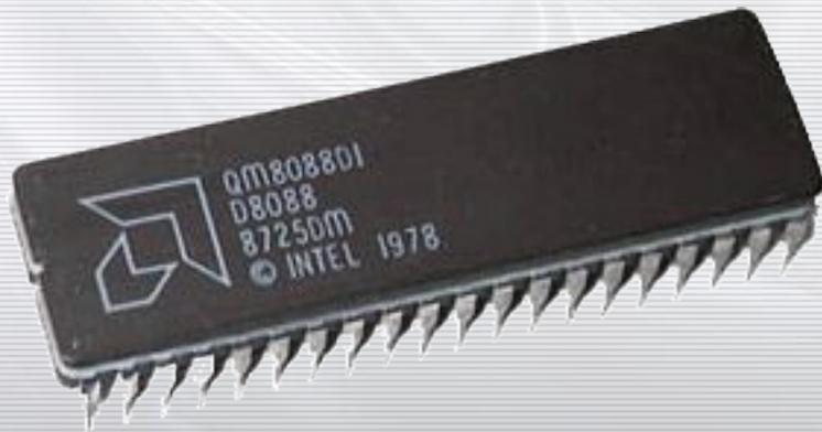
Через год после презентации *8086*, *Intel* объявила о разработке его более дешевого аналога - *8088*. Он являлся близнецом *8086*: 16-битные регистры, 20 адресных линий, тот же набор команд - все то же, за исключением одного, - шина данных была уменьшена до 8 бит. Заполнение 16-битных регистров извне теперь проходило в два раза медленнее. Как следствие -
