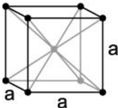
Атомы расположены в вершинах куба и один атом в центре объёма куба. Кубическую объёмно-центрированную решётку имеют металлы: K, Na, Li, Ti, Zr, Ta, W, V, Fe, Cr, Nb, Ba и др.
