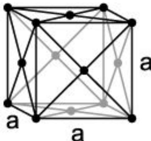
Атомы расположены в вершинах куба и в центре каждой грани. Решётку такого типа имеют металлы: Ca, Ce, Sr, Pb, Ni, Ag, Au, Pd, Pt, Rh, Fe, Cu, Co и др.
