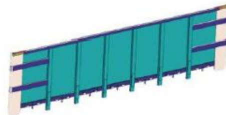
Боковая стена вагона
