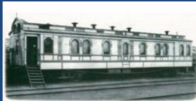
Вагон-церковь. Изготовлен на Путиловском заводе в 1896 г. Тип тележек – "сибирские", однократного подвешивания.
