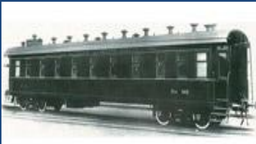
Вагон-церковь. Изготовлен на Путиловском заводе в 1896 г. Тип тележек – "сибирские", однократного подвешивания.
