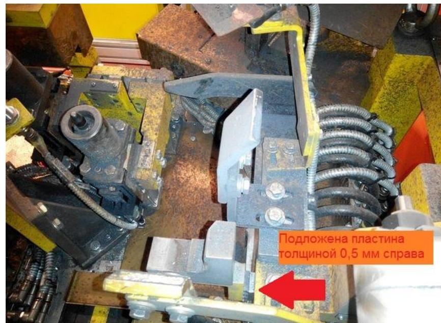
Было дополнительно проанализированы параметры LOC\_502G/502D (Расположение соединителя рычагов по оси X). В ходе анализа выявилось, что на 2 посту соединитель расположен слишком низко относительно верхних базовых втулок. Из-за этого, т.к. кронштейн крепления тормозных трубок приваривается к соединителю на оп.130, так же расположен слишком низко. Поэтому было принято решение в корректировке сварочной оснастки на 2 посту оп.140, путем изъятия регулировочных пластин толщиной 1,5 мм слева и справа.
