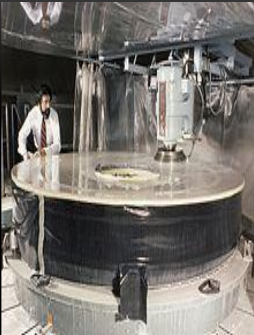
Телескоптың негізгі айнасын жылтырату, «Перкин-Элмер» компаниясы лабораториясы, мамыр, 1979 жыл.
