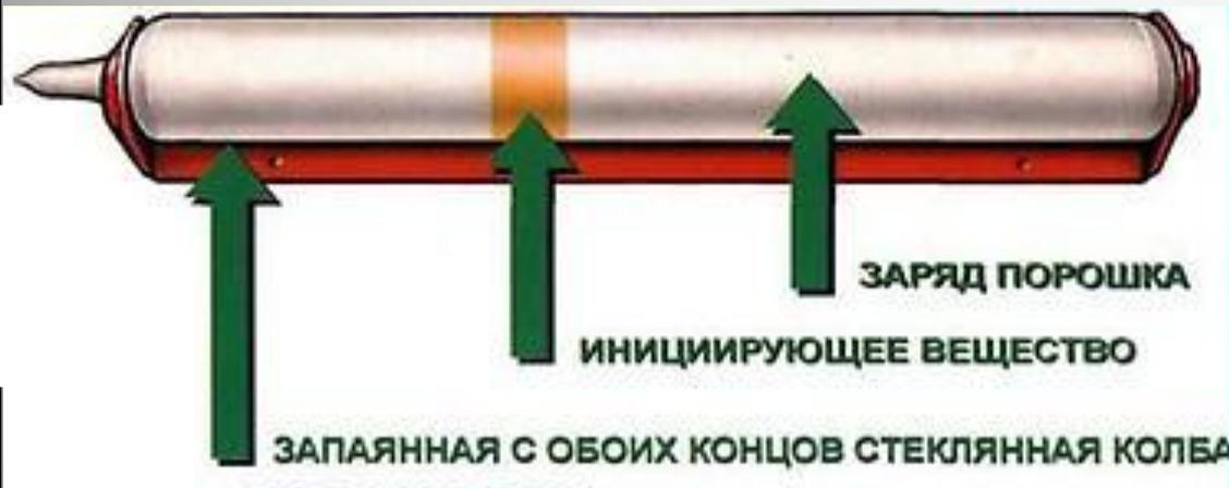
**Принцип работы ОСП** основан на разрушении стеклянного корпуса и импульсном выбросе огнетушащего порошка под воздействием избыточного давления.
