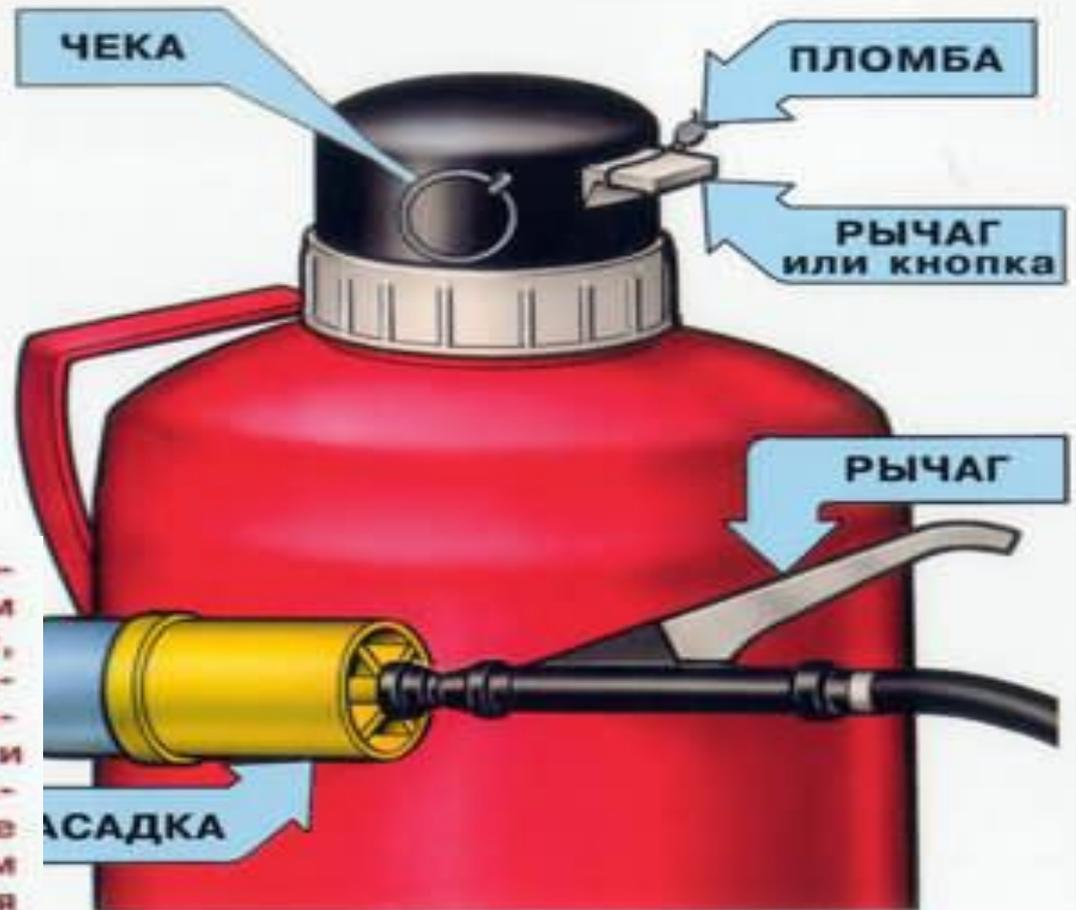
**ПРИНЦИП ДЕЙСТВИЯ.** Раствор пенообразователя вытесняется избыточным давлением рабочего газа (воздух, азот,  $\text{CO}_2$ ). При срабатывании залпрно-пускового устройства прокалывается заглушка баллона с газом, и раствор выдавливается через каналы и сифонную трубку. В насадке он перемешивается с засасываемым воздухом, образуя пену, которая охлаждает горящее вещество и изолирует его от кислорода
