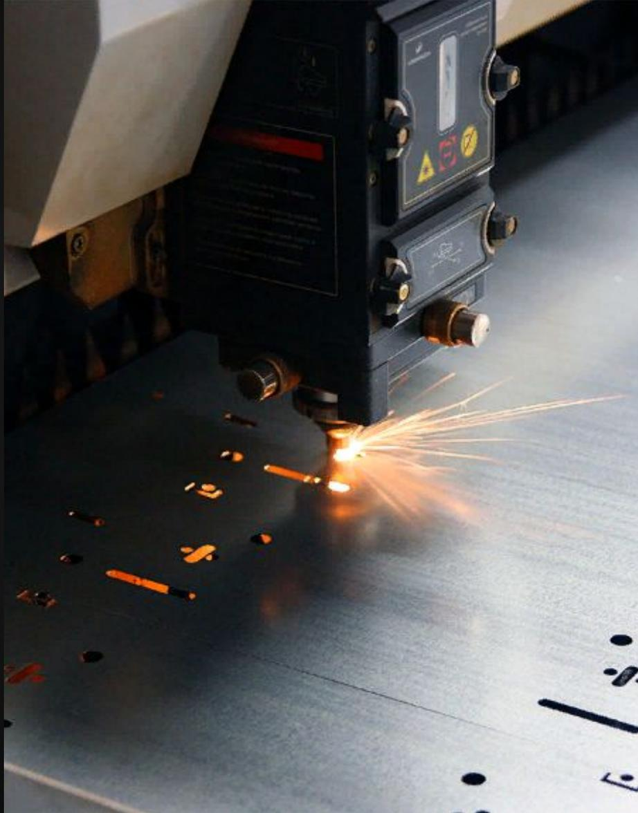
1 стадия-металл нагревается до первой температуры разрушения - плавления. Происходит расплавление металла.
