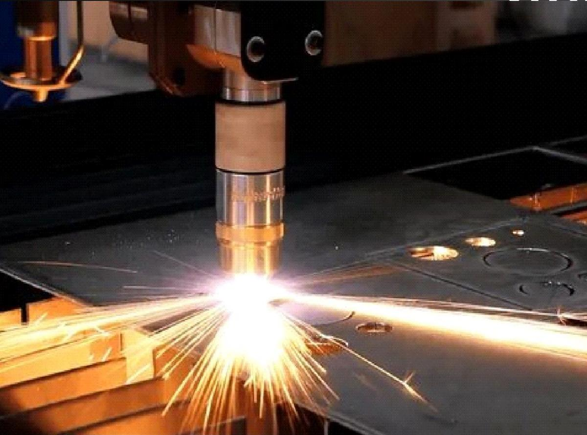
LBC - Laser Beam Cutting - резка лазерным лучом. При лазерной резке нагревание и разрушение участка материала осуществляется с помощью луча.
