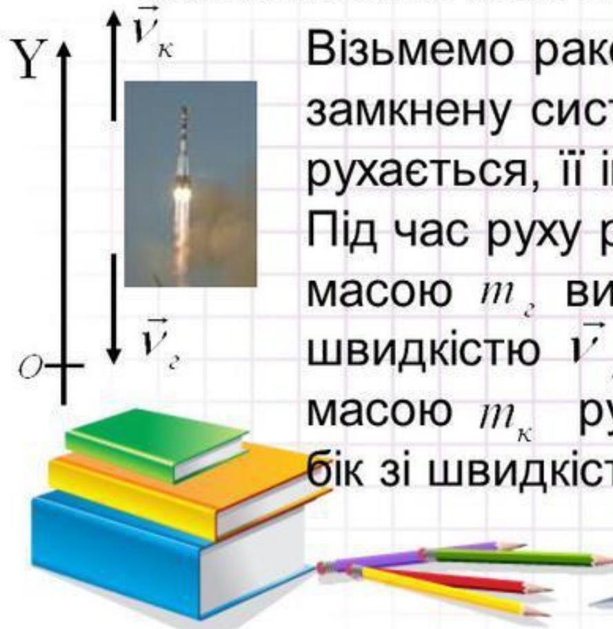
Візьмемо ракету з паливом за замкнену систему. Доки ракета не рухається, її імпульс дорівнює нулю. Під час руху ракети розжарені гази масою  $m_e$  виходять із сопла зі швидкістю  $\vec{v}_e$ , а корпус ракети масою  $m_k$  рухається в протилежний бік зі швидкістю  $\vec{v}_k$
