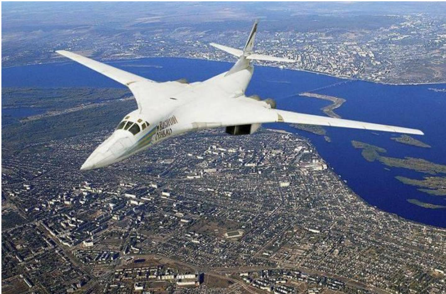
**Ту-160** — сверхзвуковой стратегический бомбардировщик-ракетоносец с крылом изменяемой стреловидности, разработанный в ОКБ Туполева в 1980-х годах.
