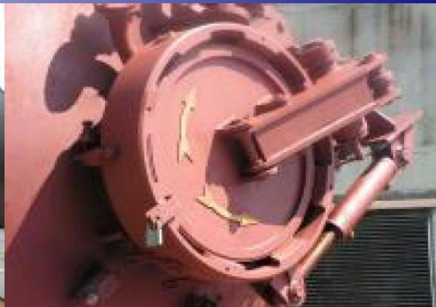
8481808501 Затворы дисковые поворотные, предназначенные для работы при температуре окружающего воздуха -40 град.С и ниже, давлении 16 Па и выше, в среде, содержащей сероводород (H<sub>2</sub>S)
