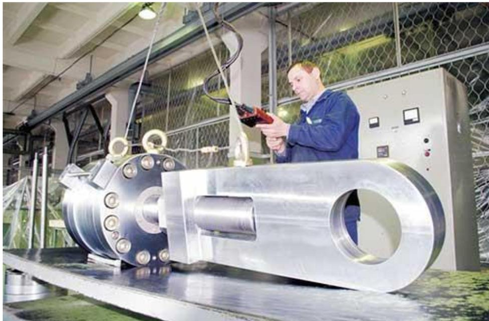
Гидроамортизаторы предназначены для ограничения перемещения оборудования и трубопроводов первого и второго контуров атомных электростанций при воздействии на них сейсмических и аварийных динамических нагрузок.
