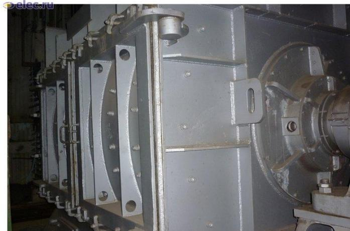
Мельницы предназначены для размола до пылевидного состояния каменных углей, полуантрацитов, тощих углей и некоторых отходов обогащения в системах топливоприготовления на тепловых электростанциях.
