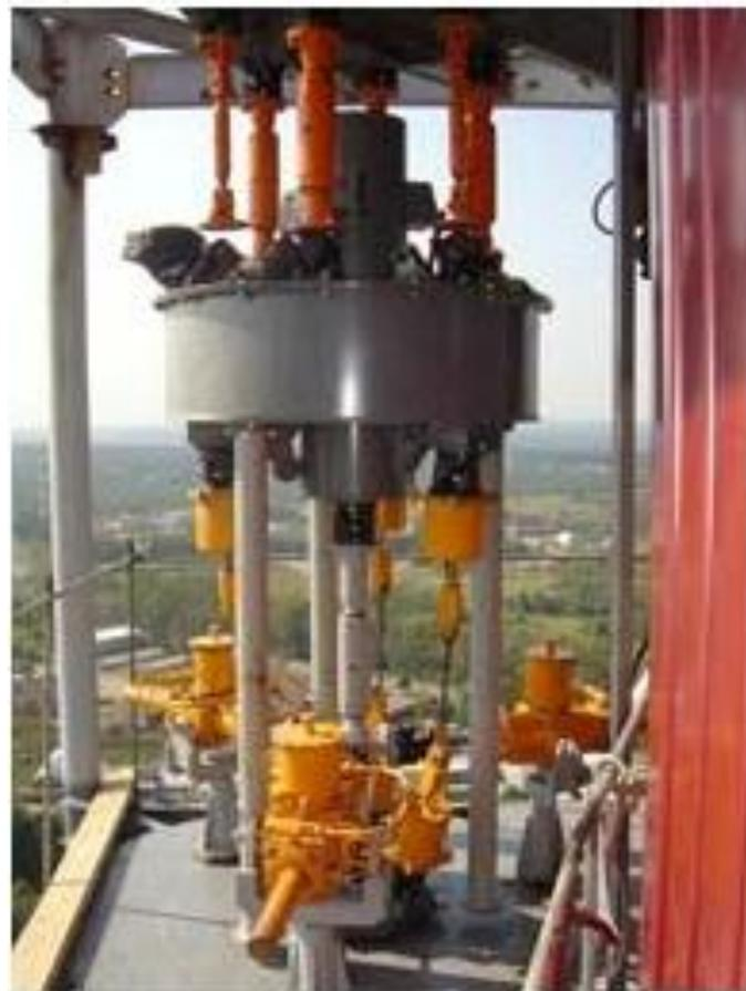
Виброгасители, применяющиеся для раскрепления трубопроводов, предназначены для ограничения (уменьшает влияние) вибрации трубопроводов, подверженных периодическим температурным деформациям в процессе эксплуатации, на бурильный инструмент, забойный двигатель, поверхностное оборудование, обслуживающий персонал и улучшает показатели бурения.
