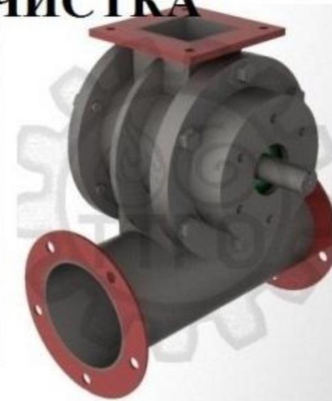
Мигалки с конусным клапаном предназначены для применения на вертикальных пылепроводах в системах непрерывного пылеприготовления под сепараторами на точках возврата и циклонами, а также в системах золоулавливания и аспирации под циклонами. Основное назначение мигалок - осыпание пыли или золы непрерывным потоком и защита сепараторов и циклонов от присосов в зону пониженного давления
