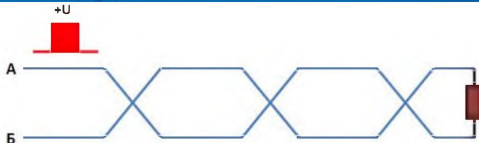
Проводники А и Б перевиты с определённым шагом. Сигнал (+U и -U) передаётся по обоим проводникам
