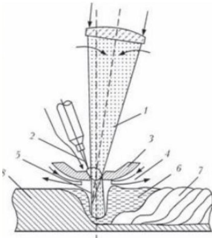
Рис. 1. Схема процесса гибридной лазерно-плазменной сварки с расположением плазменной горелки перед лазерным пучком :
