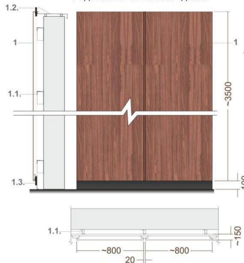
\* Типовая размерность длины панелей облицовки стен здания - 800мм
