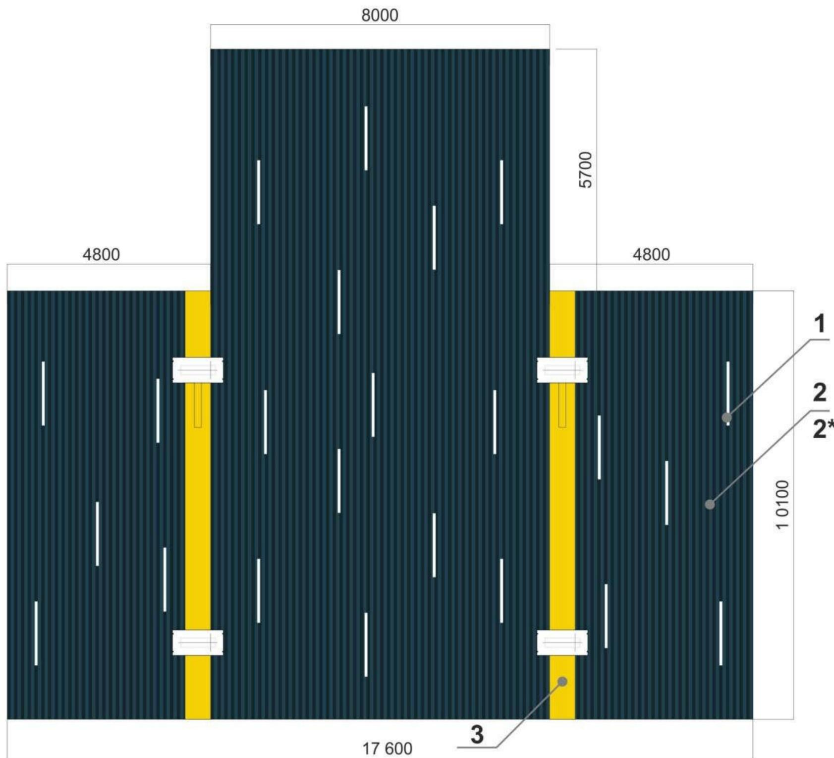
1. Линейный потолочный светильник (1200x53мм), LED MALL ECO 35 SL IP54 4000K (теплый свет), рамка светильников (если она есть) окрашивается в RAL 7024 «Графит».
