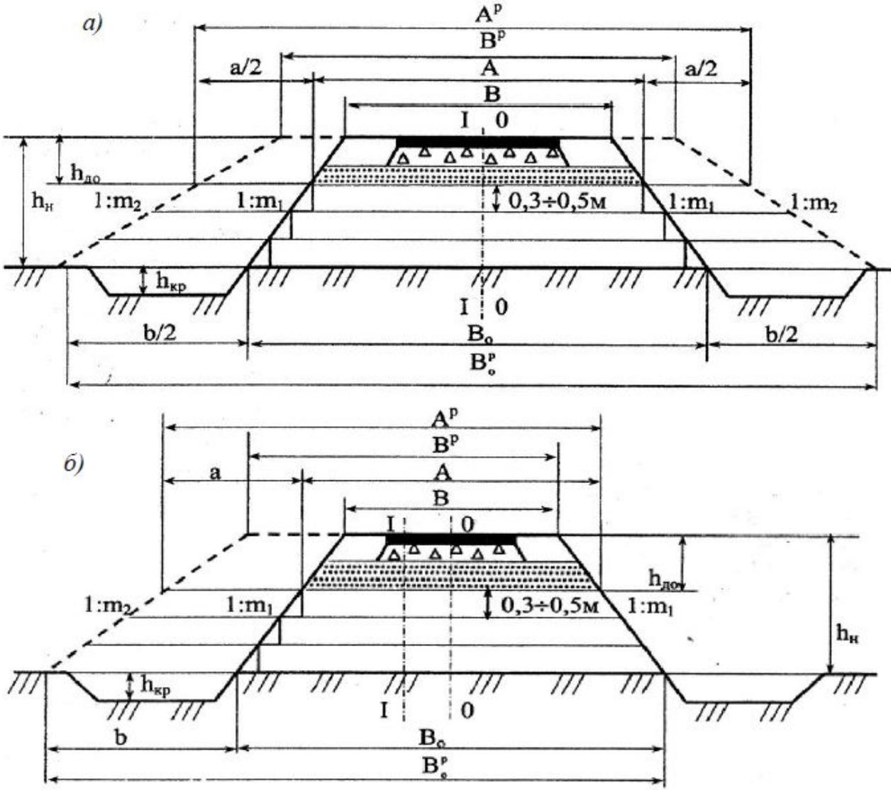
Рис. 1. Схема реконструкции земляного полотна при уширении:
