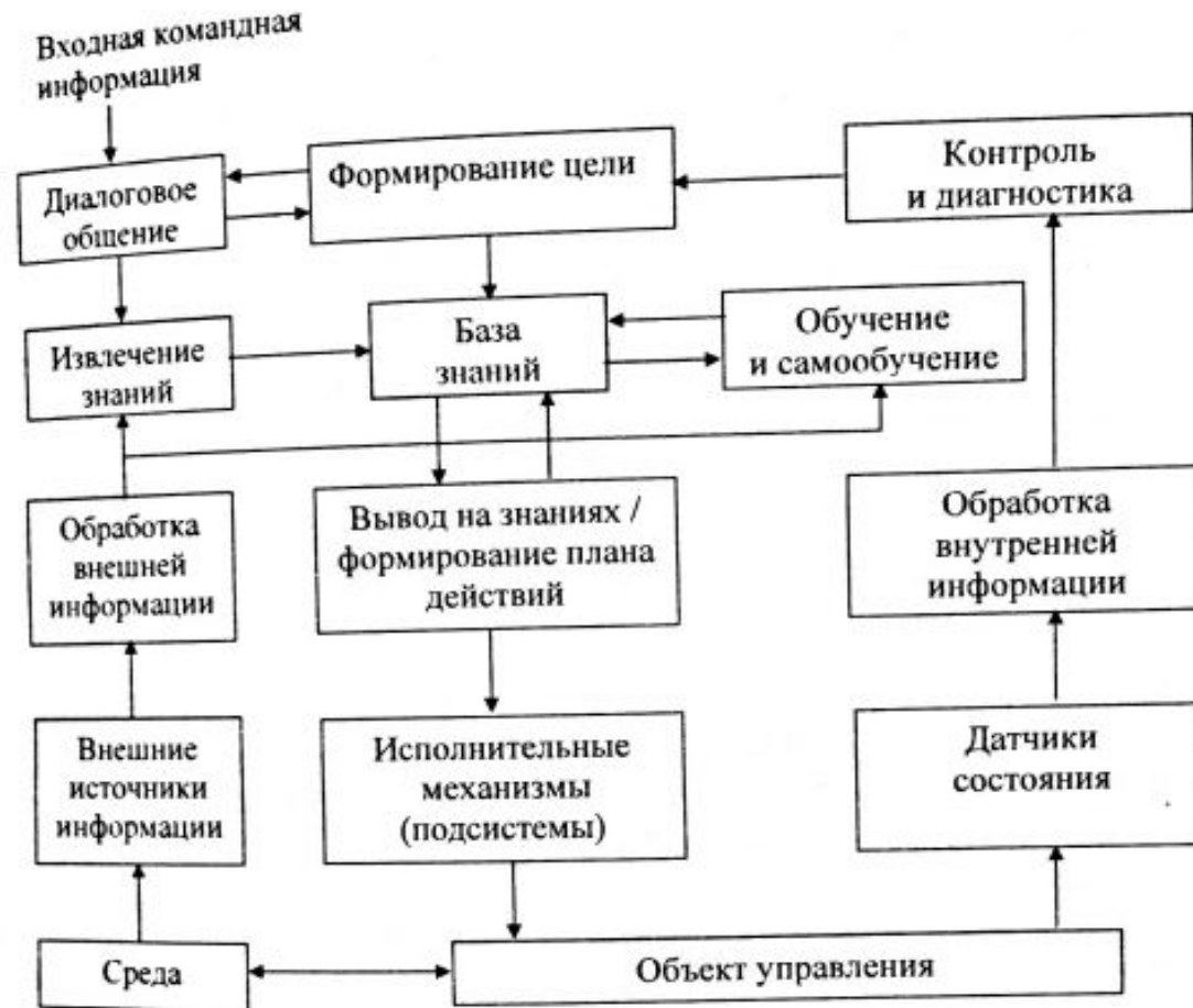
Рис. 1.5. Обобщенная структура интеллектуальной системы управления
