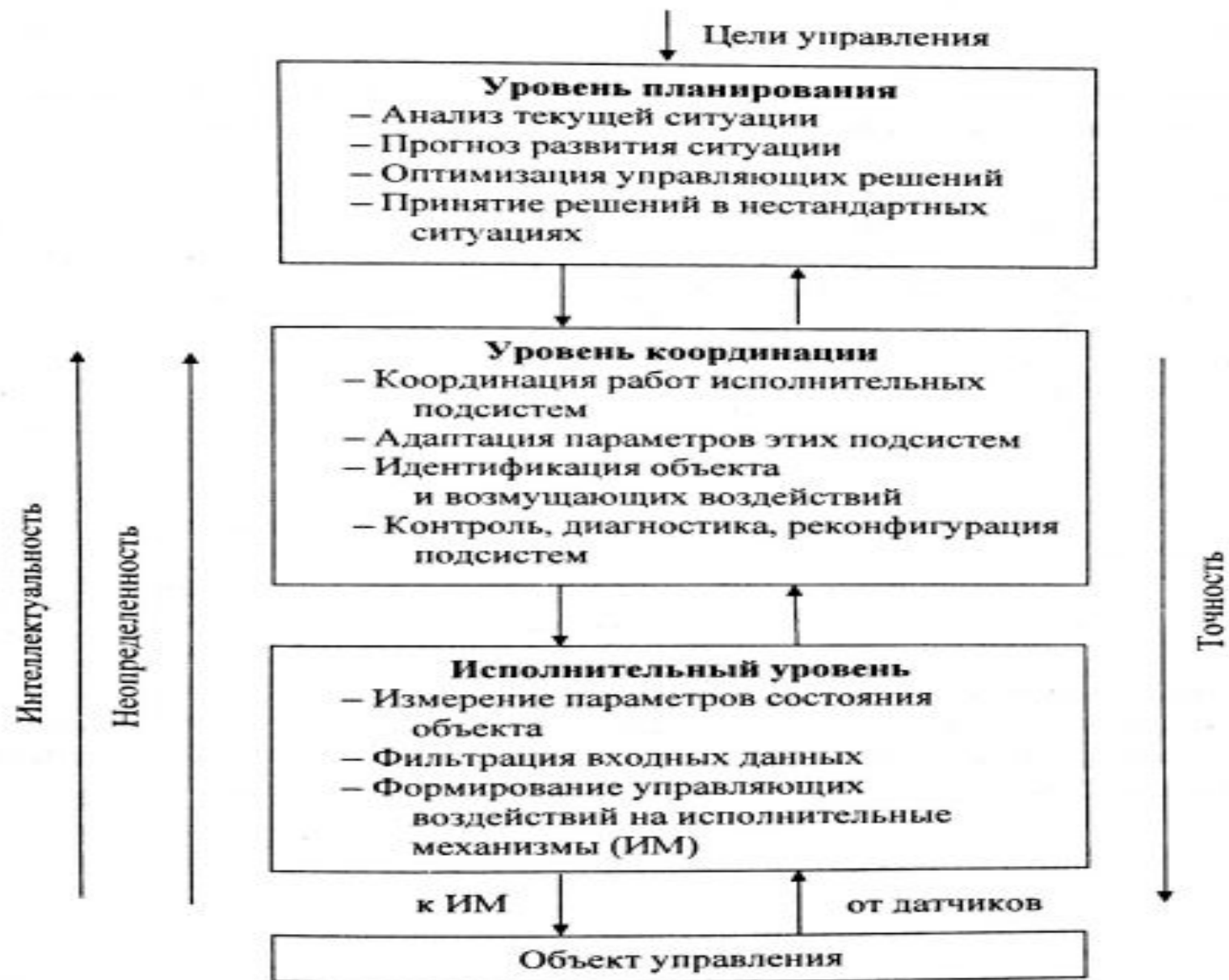
Рис. 1.4. Схема функциональной организации интеллектуальной системы управления
