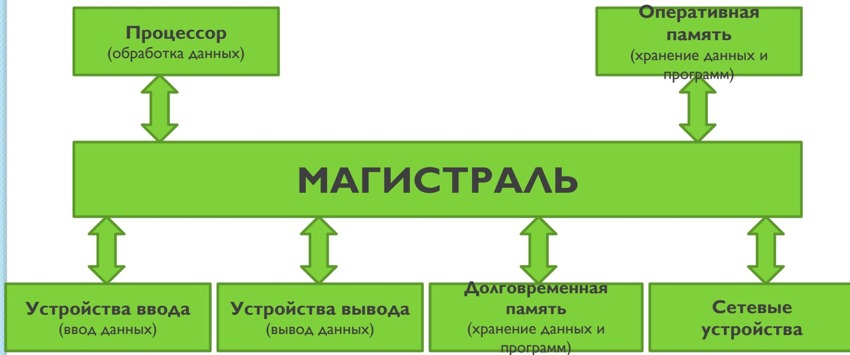
В основу архитектуры современных ПК положен магистрально-модульный принцип
