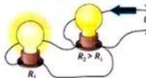
При параллельном соединении лампа с большим сопротивлением горит слабее
