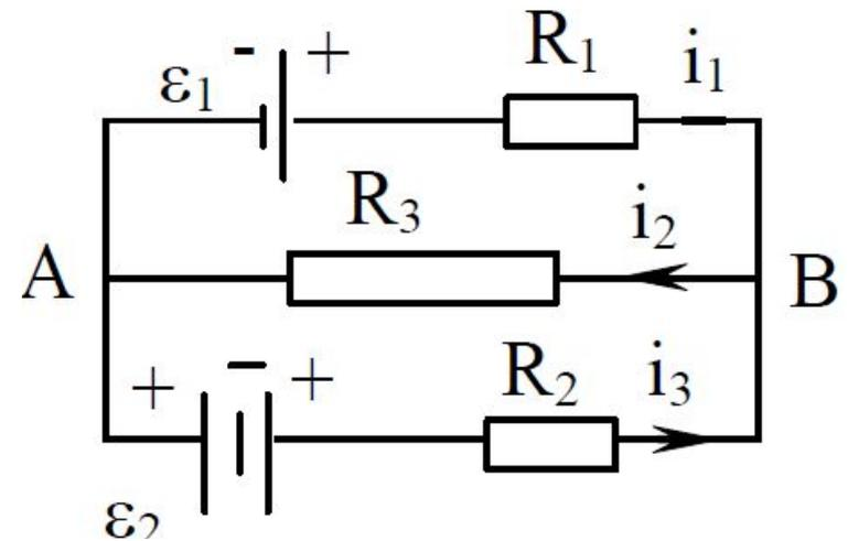
Для узла В:  $i_1 + i_2 = i_3$ .
