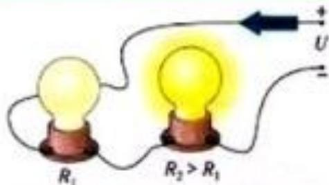
При последовательном соединении лампа с большим сопротивлением горит ярче
