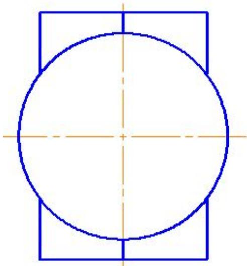
**Построение линии пересечения начинают с определения опорных точек (точек пересечения ребер многогранника с кривой поверхностью), а затем определяют достаточное количество произвольных точек.**
