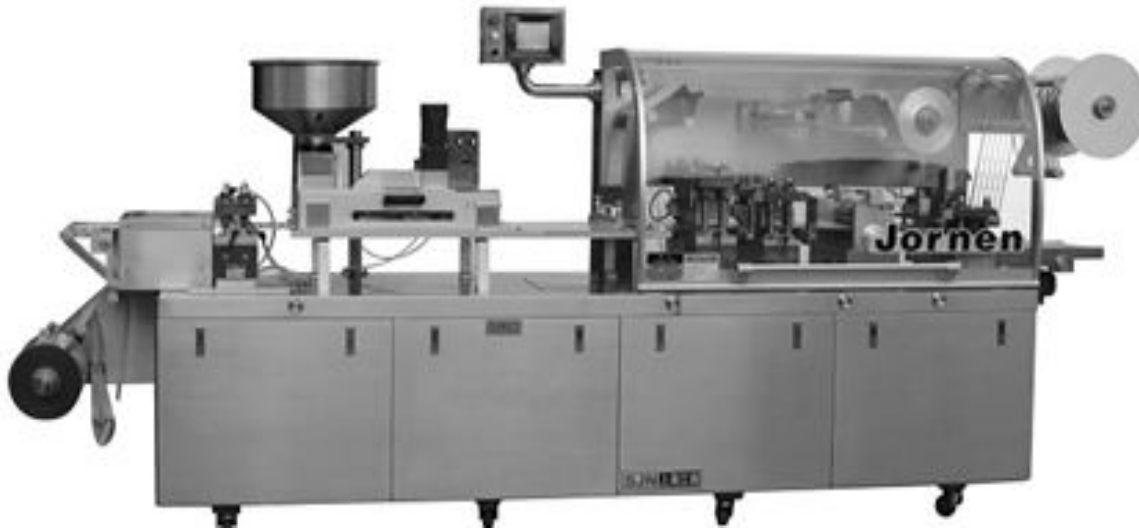
Блістерна машина DPR260K2 Виробник: Jornen (Китай)
