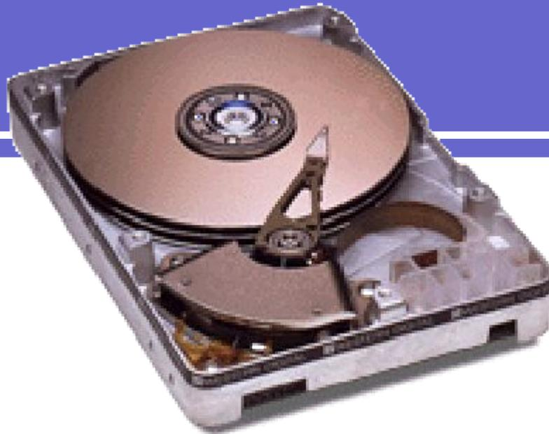
Накопитель на жёстких магнитных дисках, жёсткий диск или винчестер, (англ. Hard Disk Drive, англ. HDD
