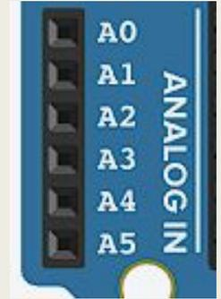
Для чтения показания напряжения есть встроенный метод `analogRead()`, возвращающий значение от 0 до 1023. Значение 0 относится к 0V, а 1023 к 5V. Таким образом, если мы хотим конвертировать значение от 0 до 5, то нужно произвести деление  $1023/5 = 204.6$
