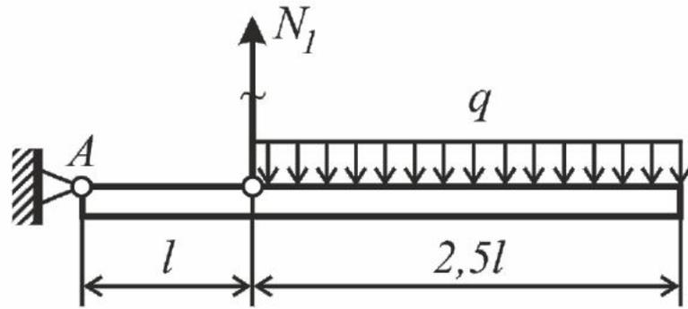
$$\begin{aligned}\sum M_A &= N_1 \cdot l - q \cdot 2,5l \cdot (l + 2,5l / 2) = 0; \\ N_1 &= 5,625ql = 5,625 \cdot 200 \cdot 10^3 \cdot 0,5 = \\ &= 562,5 \text{ кН. В стержне 1 растяжение.}\end{aligned}$$
