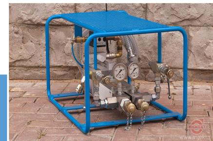
Минеральные (на основе цементов) инъекционные составы, как правило, подаются под гораздо меньшим давлением (до 20 атм.), что обусловлено наличием в минеральных составах твердых частиц различных фракций. «Цементные» пакеры, также имеют свои конструктивные отличия, например, в способе соединения с насосом, а также с наличием и конструкцией обратного клапана
