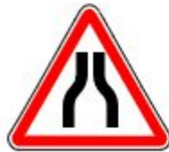
Знак 1.20.1. Сужение дороги.
