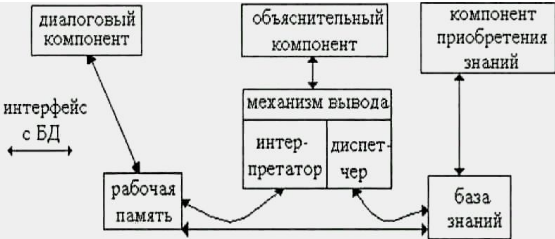
Рис.3. Структура статической ЭС
